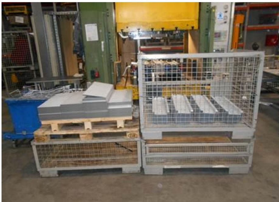
Slika 18 Štancanje komada na alatu
