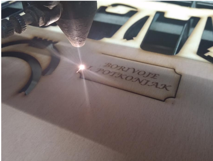
Slika 4: Lasersko graviranje i izrezivanje
