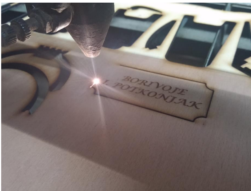
Slika 26: Izrezivanje obradka laserom
