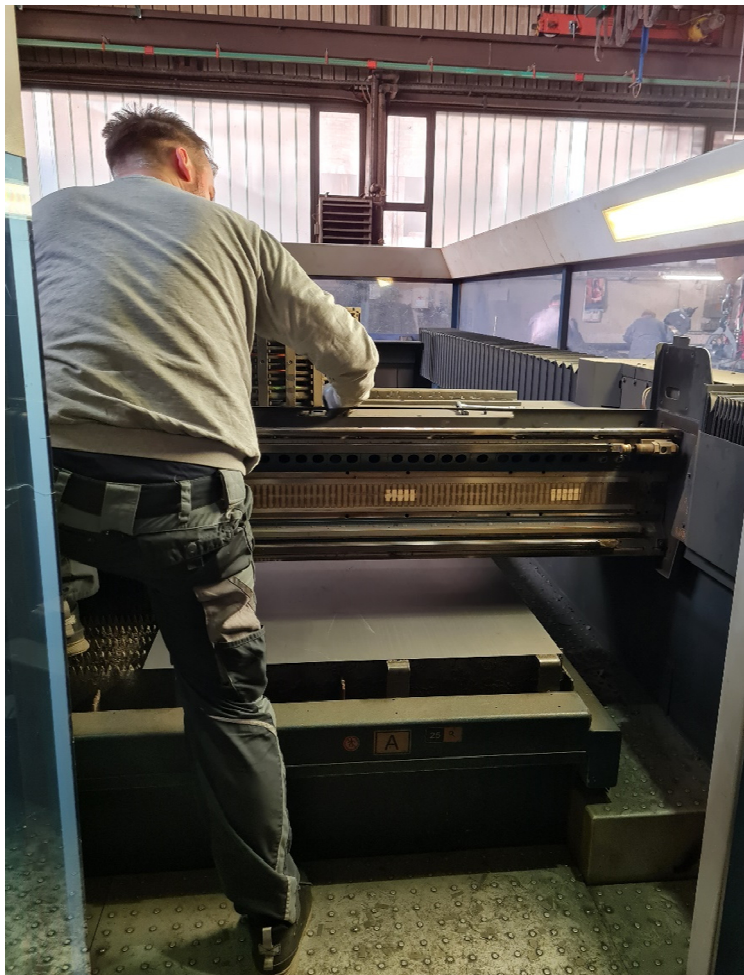
Slika 19. Vizualna kontrola x,y i z vodilica laserske glave
