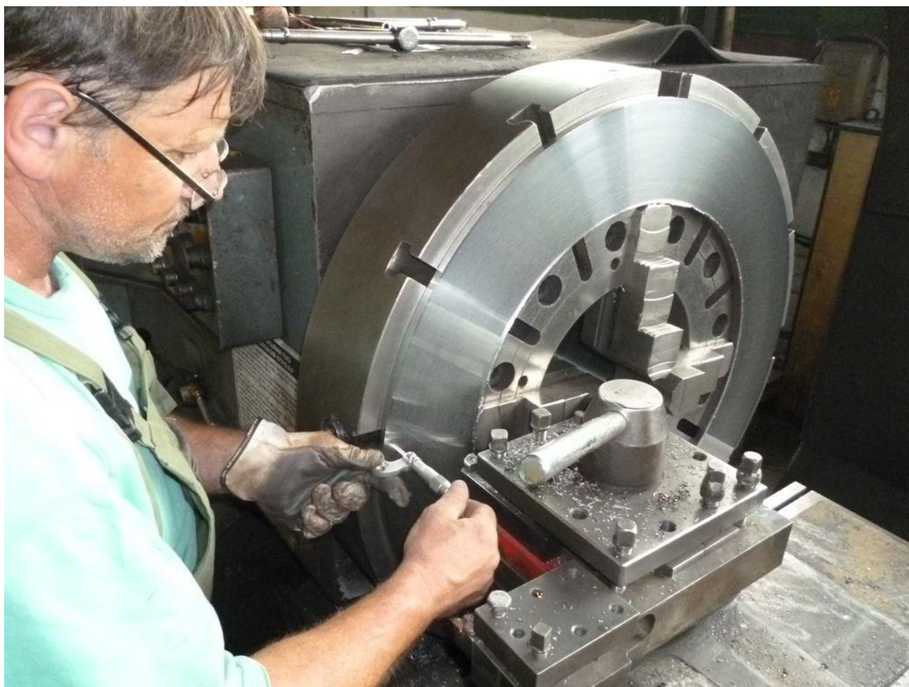
Slika 15. Obrada tokarenjem na zadanu debljinu
