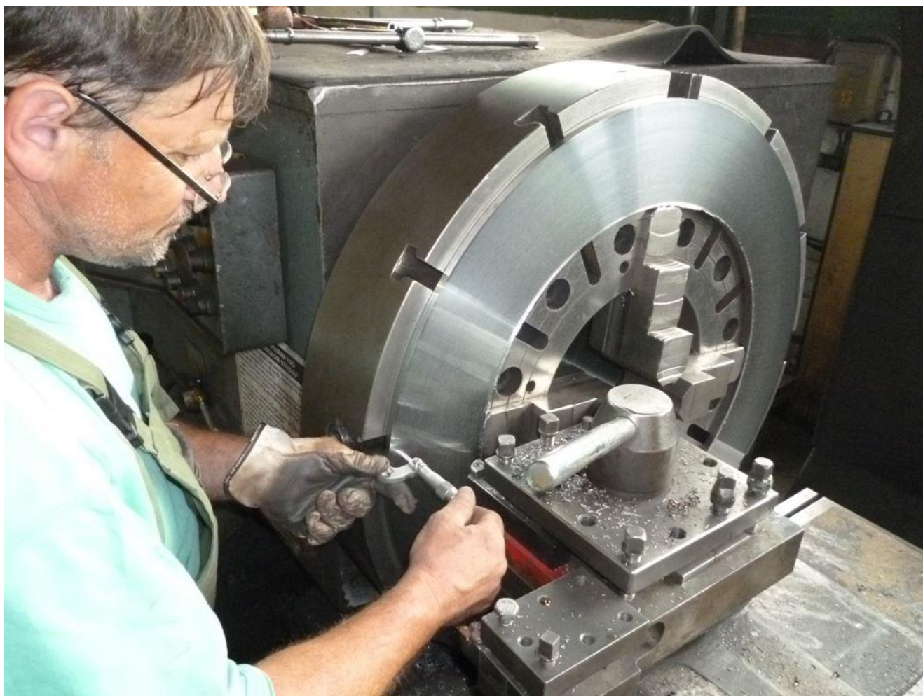
Slika 15. Obrada tokarenjem na zadanu debljinu
