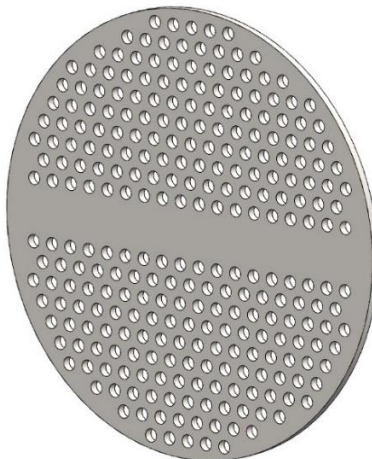
Slika 34 Cijevna ploča izmjenjivača
