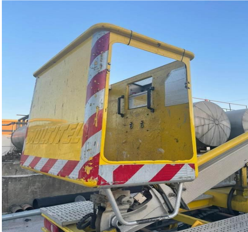
Slika 12. Izolirana hidraulička platforma 1000V [Vlastiti izvor]
