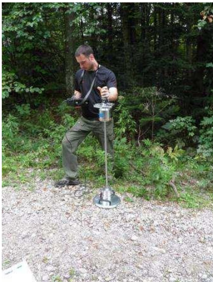
Slika 7. Provedba mjerenja nosivosti šumske ceste (Branišelj, S. 2013)
