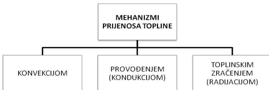
Slika 6. Podjela izmjenjivača topline prema mehanizmu prijelaza topline
