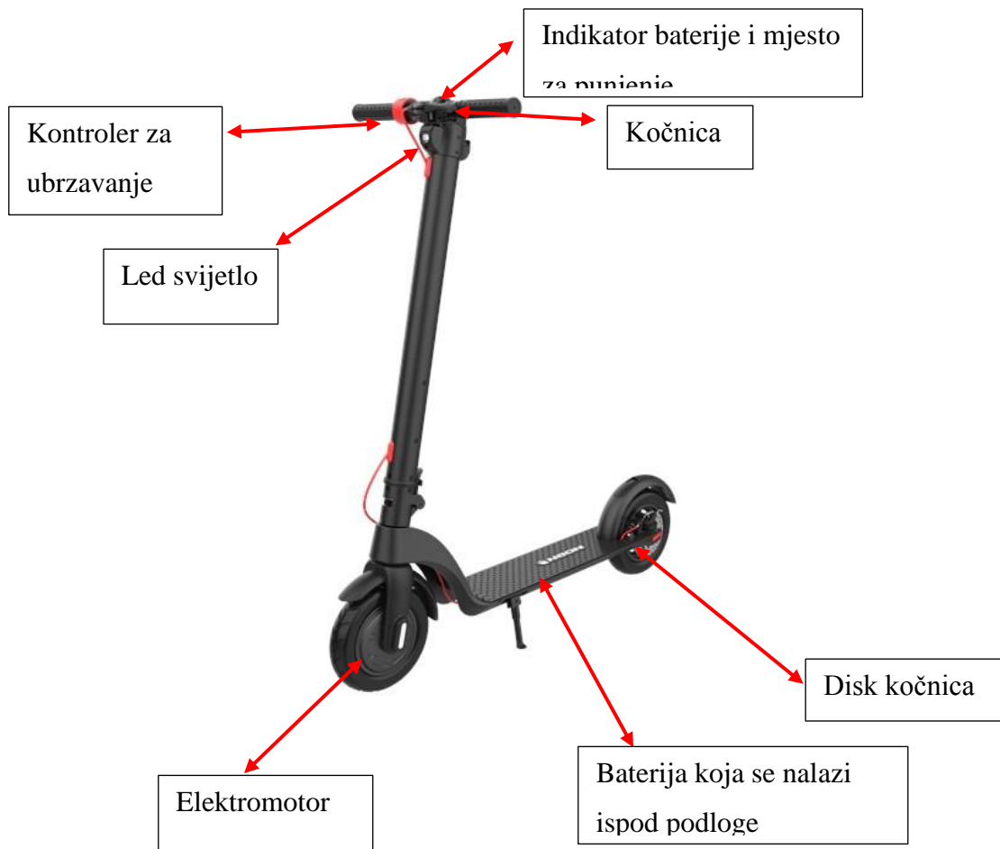
Slika 1. Dijelovi električnog romobila (izvor: www.technostore.hr )
