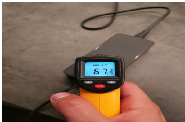
Slika 5. Mjerenje temperature punjača (Izvor: www.reddit.com )
