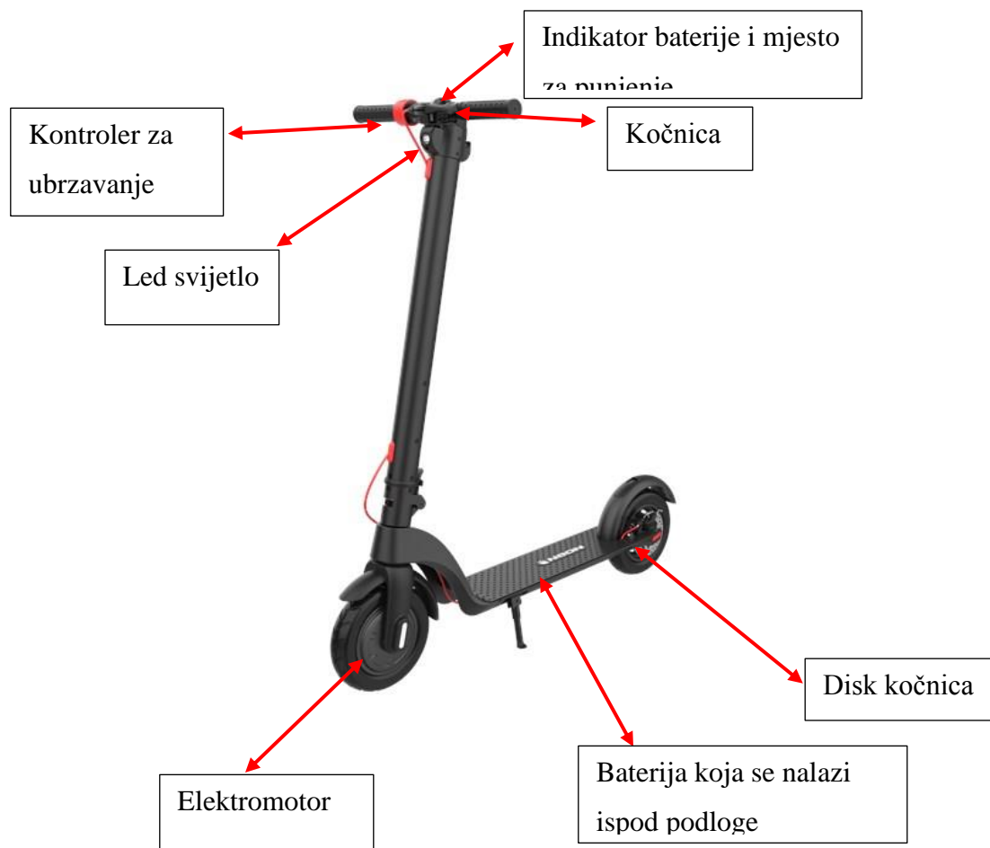
Slika 1. Dijelovi električnog romobila (izvor: www.technostore.hr )
