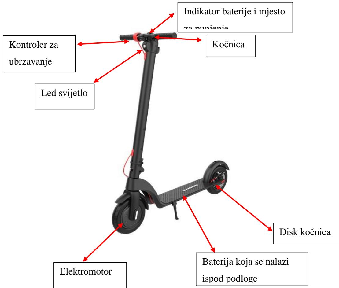
Slika 1. Dijelovi električnog romobila (izvor: [www.technostore.hr](http://www.technostore.hr))
