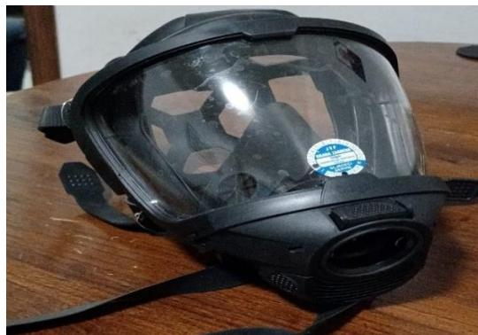
Slika 14. Maska za cijelo lice (Vlastita izrada)
