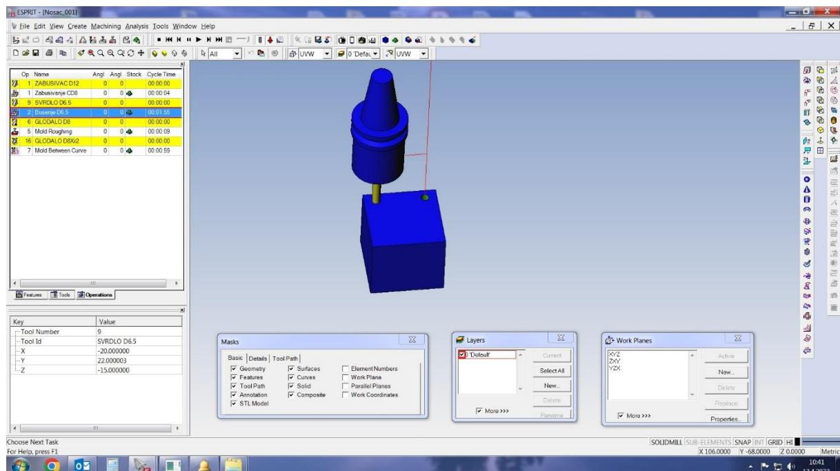
Slika 11. Prikaz simulacije bušenja prvrta Ø6.5 mm
