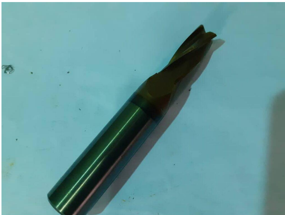
Slika 6. Fino tvrdometalno glodalo s 4 oštice–prebrušeno na manji promjer [5]
