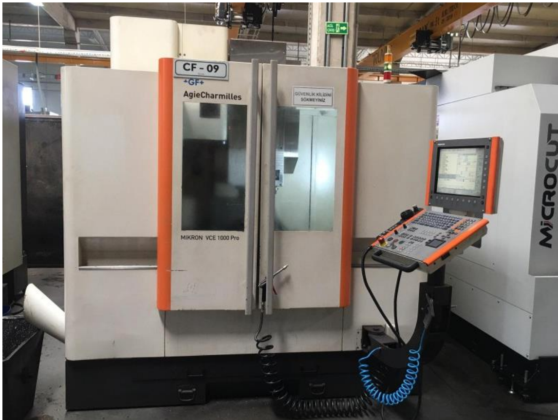
Slika 1. CNC GLODALICA Mikron VCE 1000 Pro [9]
