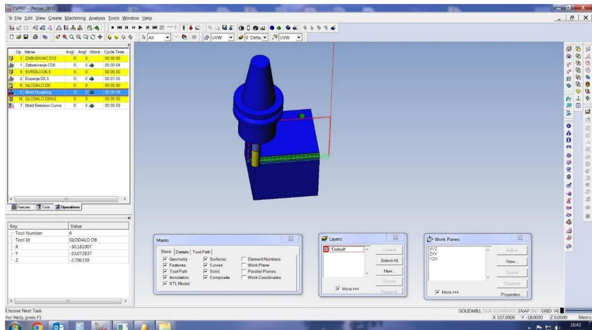
Slika 13. Prikaz simulacije glodanja skošenja
