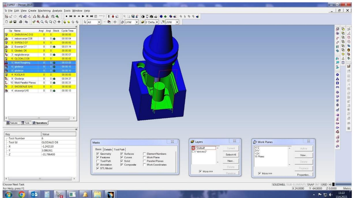
Slika 19. Prikaz simulacije grubog i finog glodanja unutrašnosti oslonca
