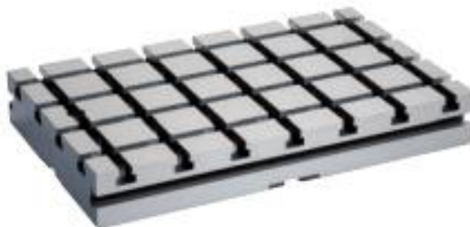
Slika 13. Pravokutna osnovna ploča 420x230x70 mm - 3D prikaz [3]
