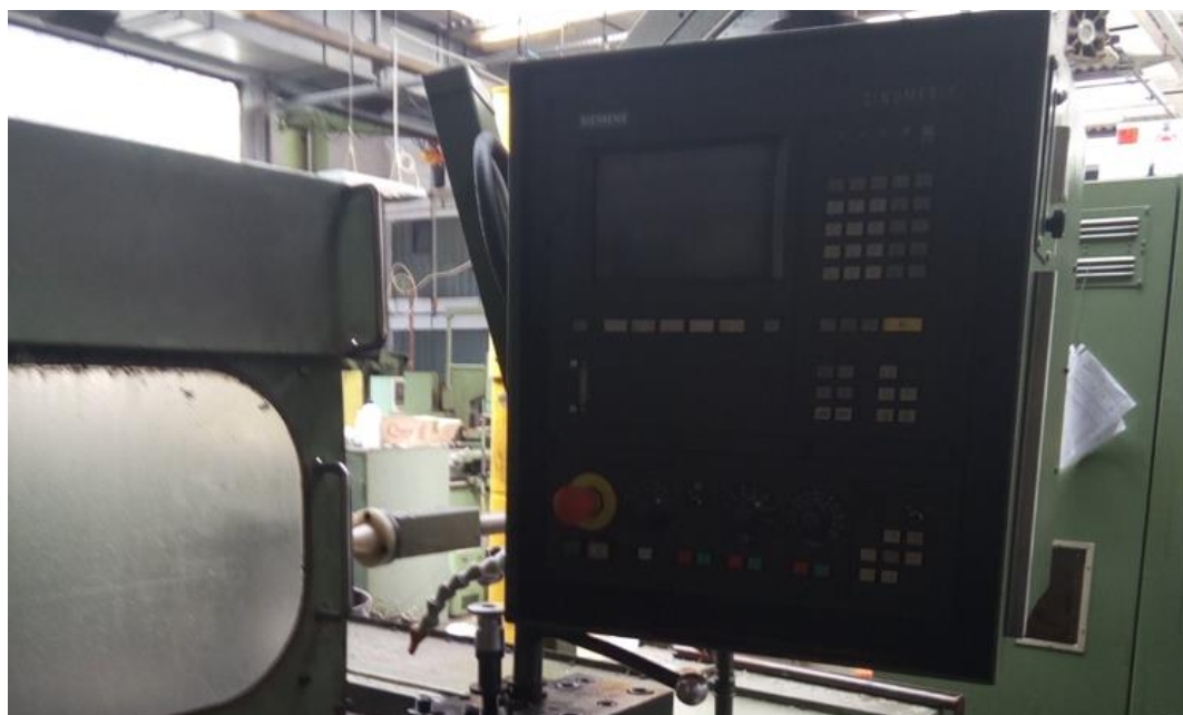
Slika 32. Upravljačka jedinica CNC tokarilice
