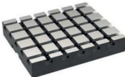
Slika 5. Osnovna ploča 240x200x40 mm - 3D prikaz [3]
