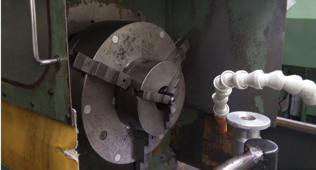
Slika 33. Stezna glava na CNC tokarilici
