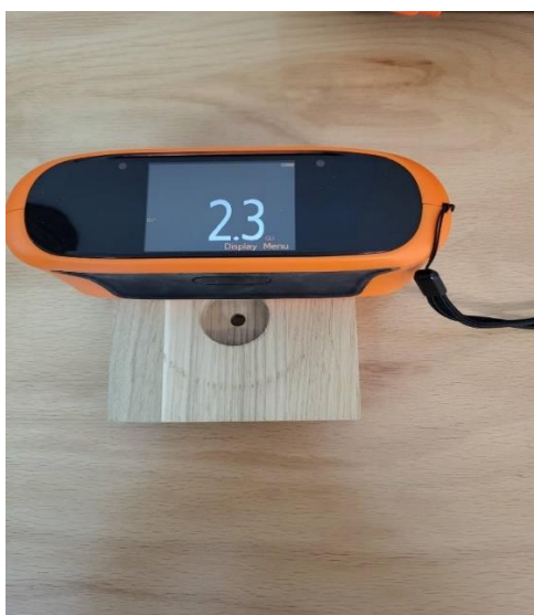
Slika 30. Prikaz mjerenja sjajnosti površine
