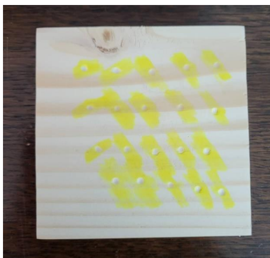
Slika 48. Prikaz otisaka čelične kuglice na uzorku jelovine
