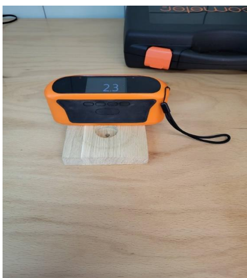
Slika 29. Prikaz uređaja za mjerenje sjajnosti površine
