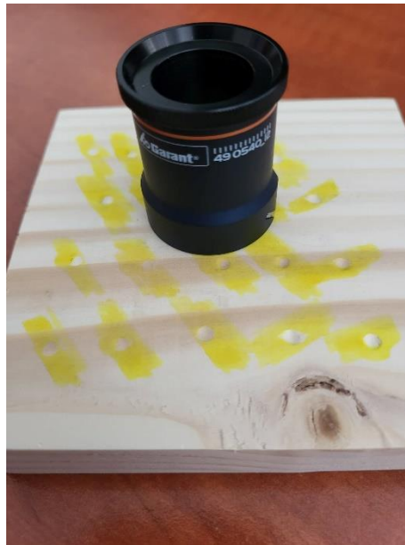
Slika 50. Prikaz mjerenja promjera otiska čelične kuglice
