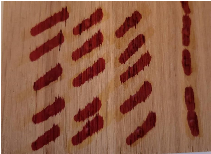
Slika 49. Prikaz otisaka čelične kuglice na uzorku hrastovine
