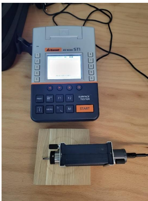
Slika 37. Prikaz mjerenja hrapavosti površine
