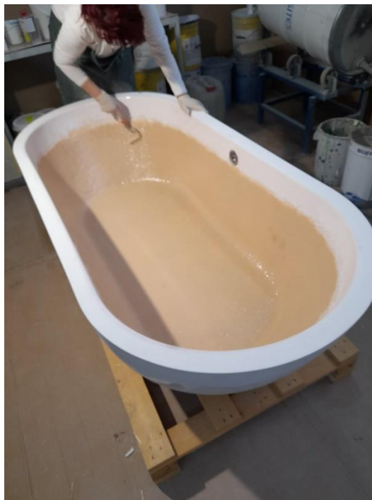
Slika 20. Sloj vlakna i smole.
