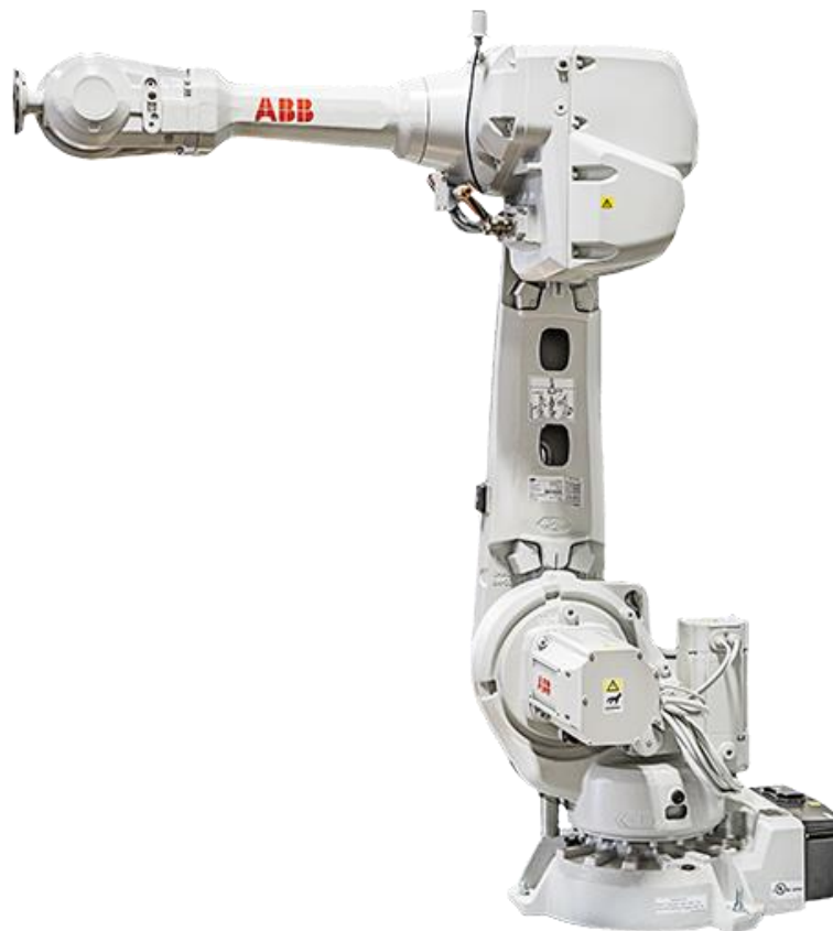
Slika 35. Robot ABB IRB 4600 [23].
