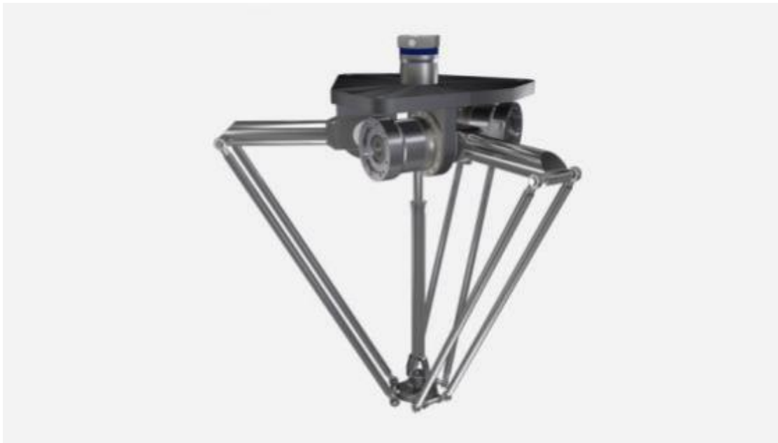
Slika 10. Paralelni robot (Delta robot) [16].
