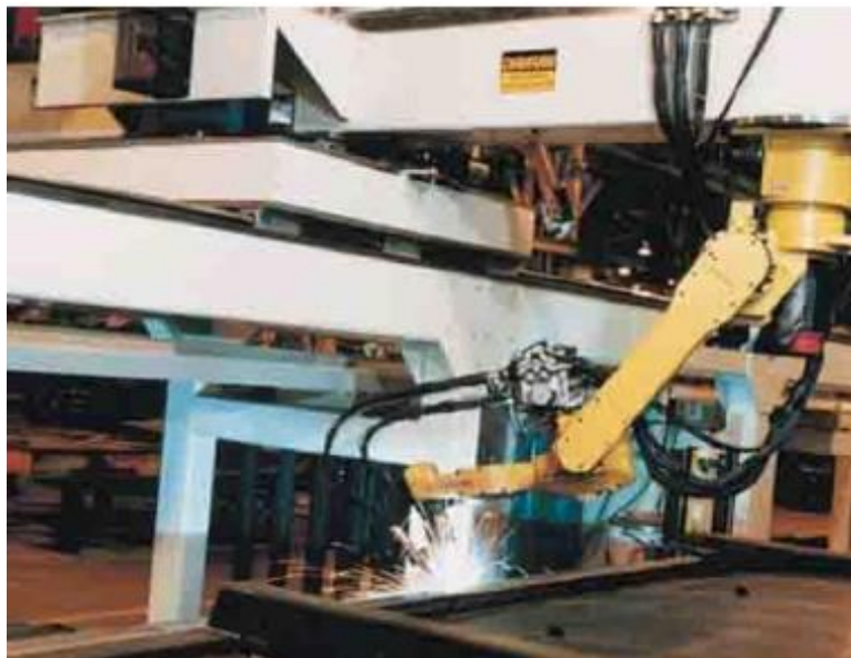
Slika 5. Zavarivanje kartezijskim robotom [11].
