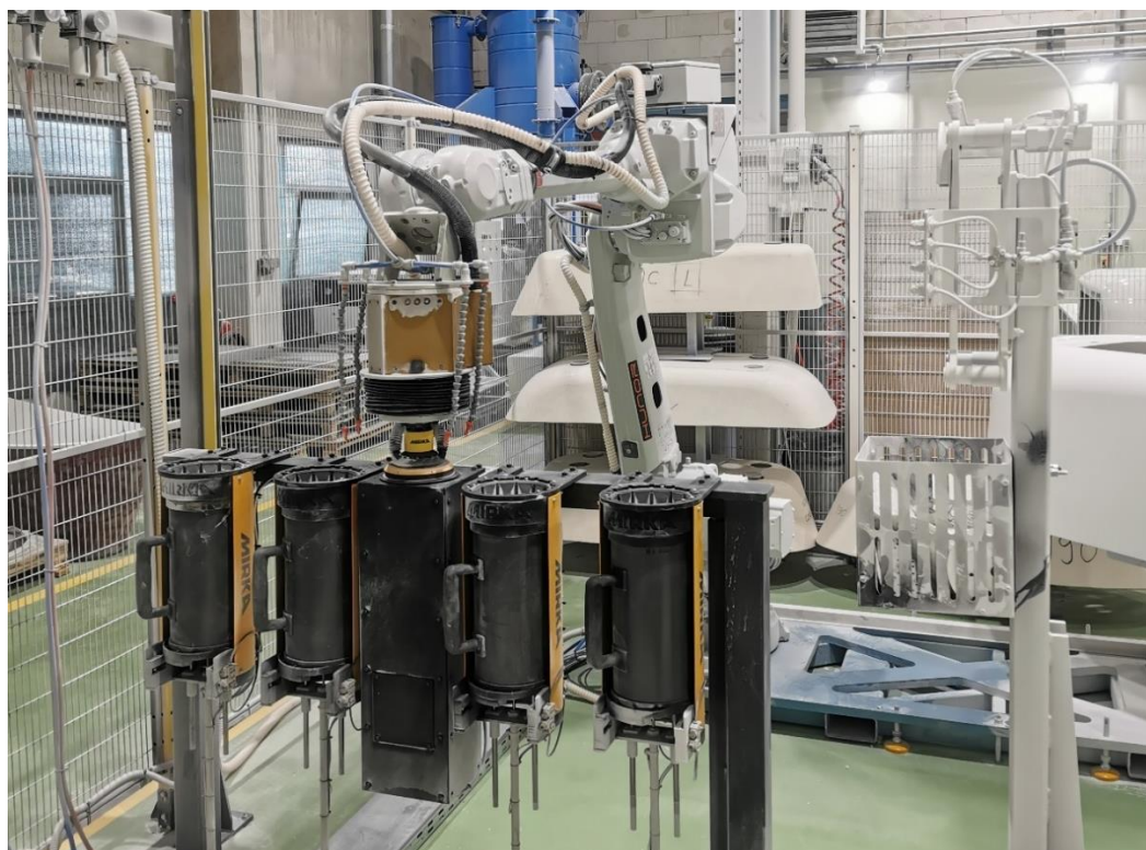
Slika 49. Kamera na robotu
