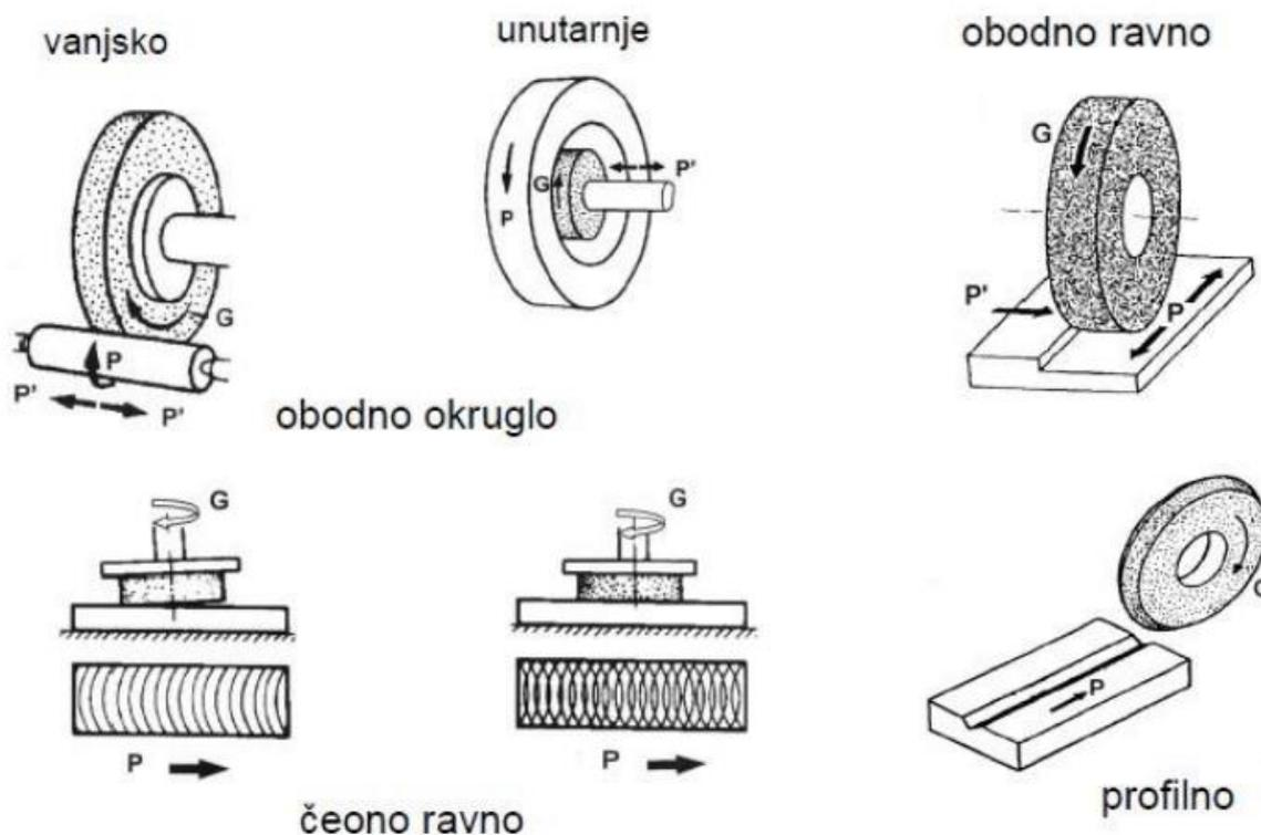
Slika 15. Podjela brušenja prema obliku obrađene površine [21].
