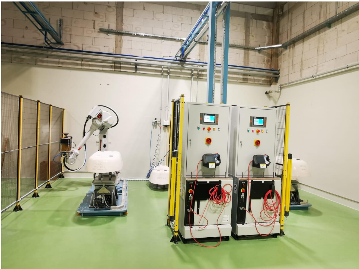
Slika 14. Roboti za brušenje kada u Aquaestilu.
