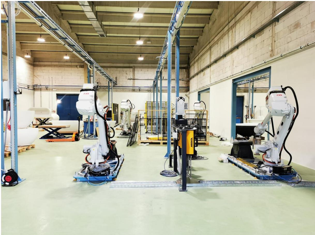
**Slika 52. Roboti za brušenje i izmjenjivač papira**
