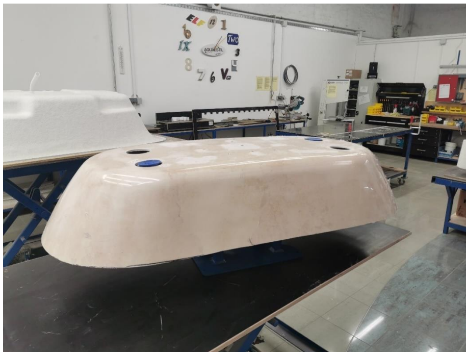
Slika 30. Negativ za brušenje kade Form (pogled izvana).
