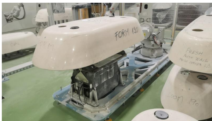
Slika 33. Okretni stol robota sa negativom za kade Form.
