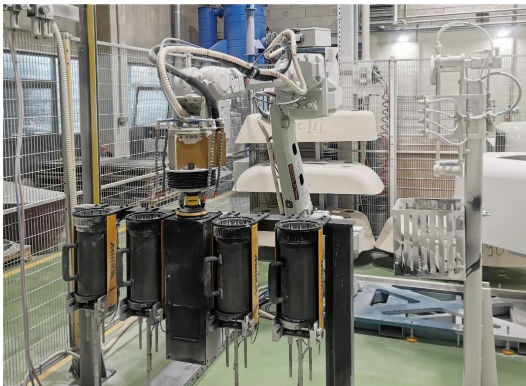
**Slika 49. Kamera na robotu**
