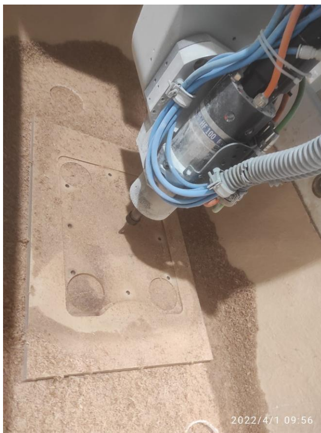
Slika 24. Glodanje utora za metalno postolje.
