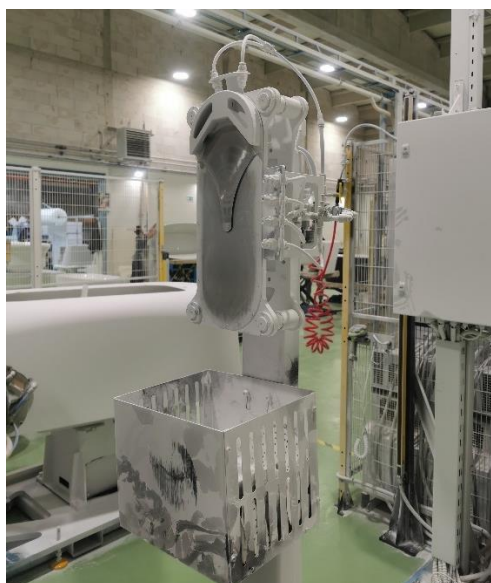
Slika 51. „Nož“ za skidanje brusnog papira
