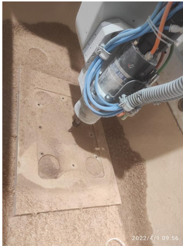
Slika 24. Glodanje utora za metalno postolje.
