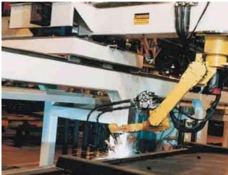
**Slika 5. Zavarivanje kartezijskim robotom [11].**
