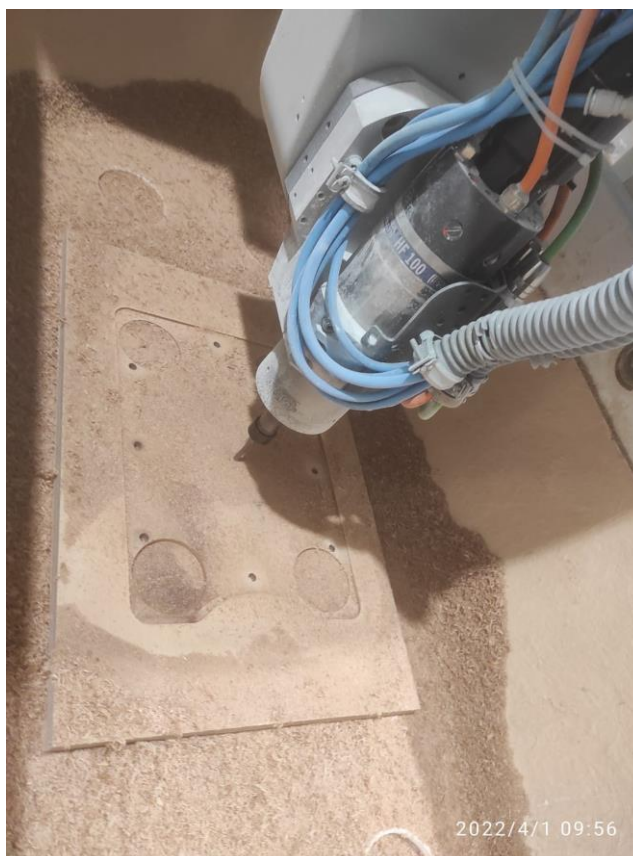
Slika 24. Glodanje utora za metalno postolje.
