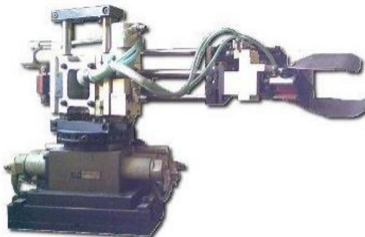
**Slika 9. Cilindrični robot [15].**
