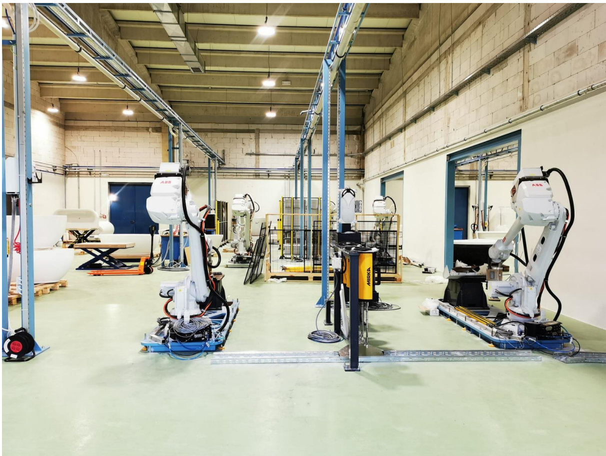
Slika 52. Roboti za brušenje i izmjenjivač papira
