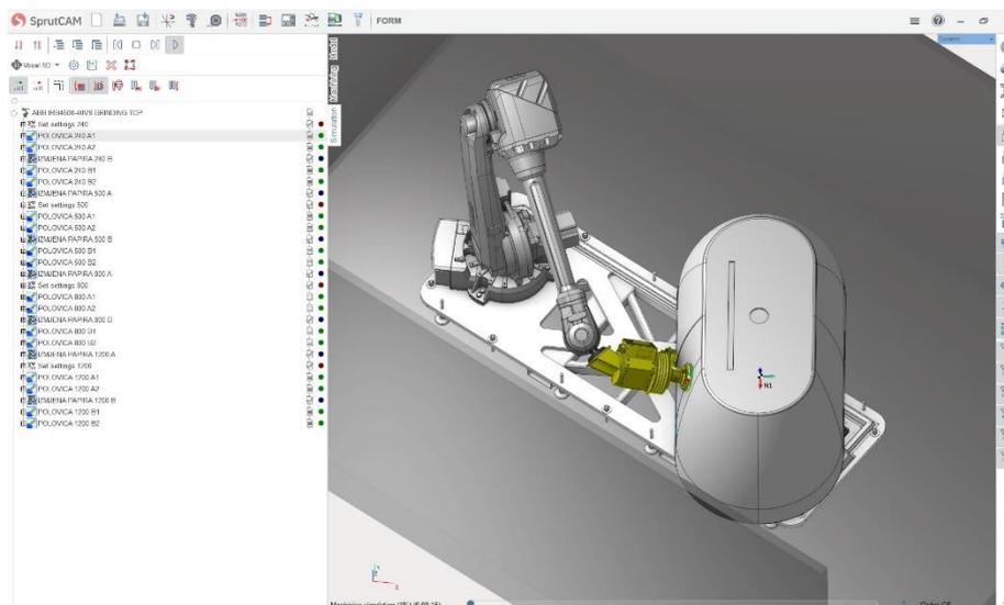
**Slika 45. Površine brušenja kade Form**
