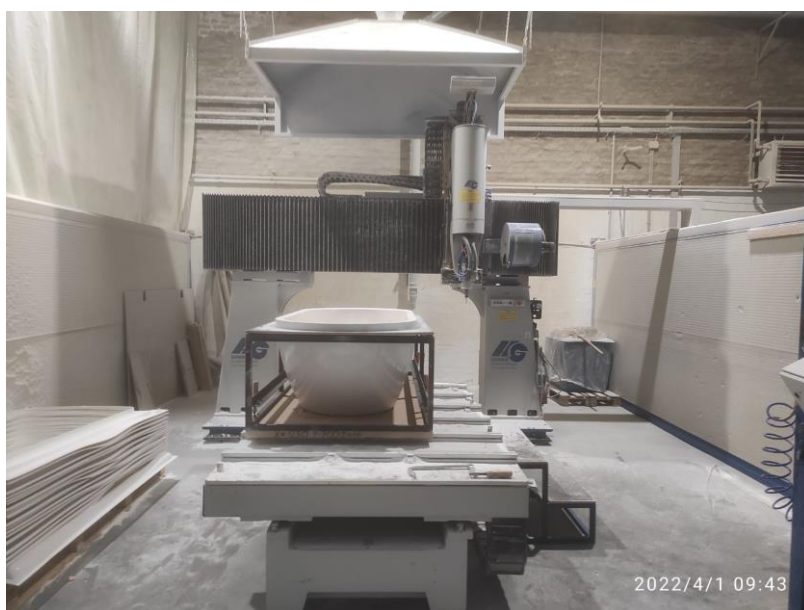
Slika 23. Priprema za glodanje utora.
