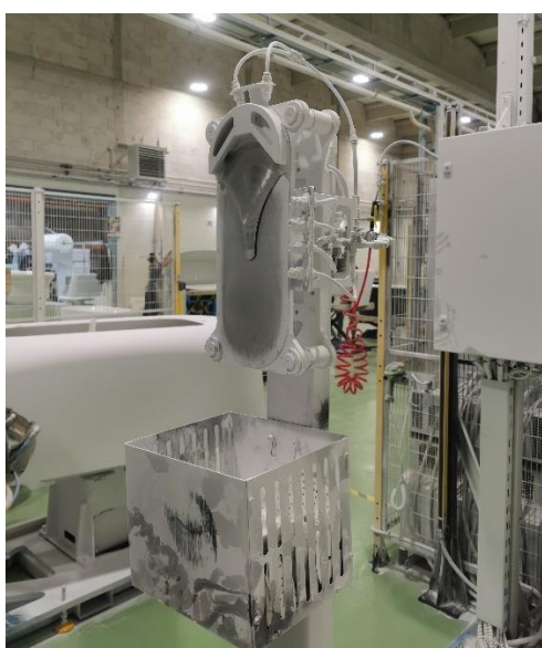
Slika 51. „Nož“ za skidanje brusnog papira
