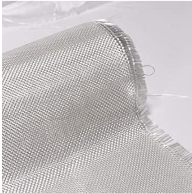
Slika 20-Platno od staklenih vlakna [32]
