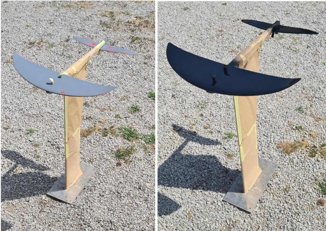
Slika 56-Krila prije lakiranja (ljevo), krila nakon lakiranja (desno)
