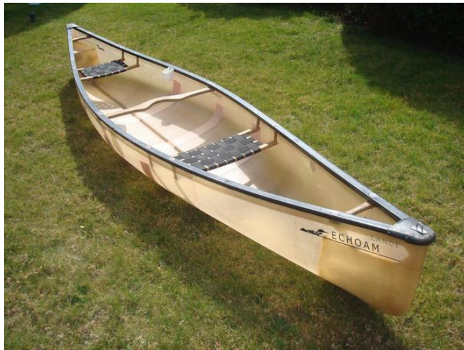
Slika 21-Kanu napravljen od staklenih vlakna [33]
