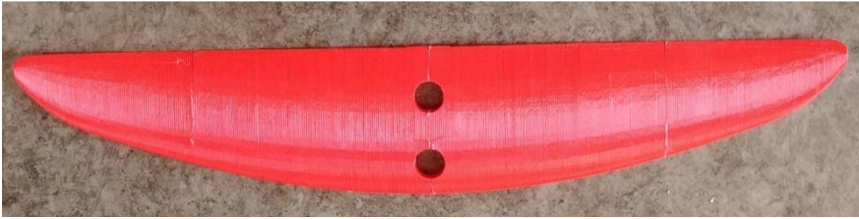
Slika 47-Ispisano zadnje krilo (pogled odozgo)
