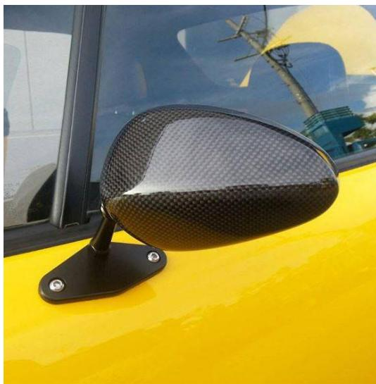
Slika 23-Proizvod napravljen od ugljičnih vlakna [35]
