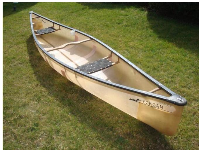
*Slika 21-Kanu napravljen od staklenih vlakna [33]*
