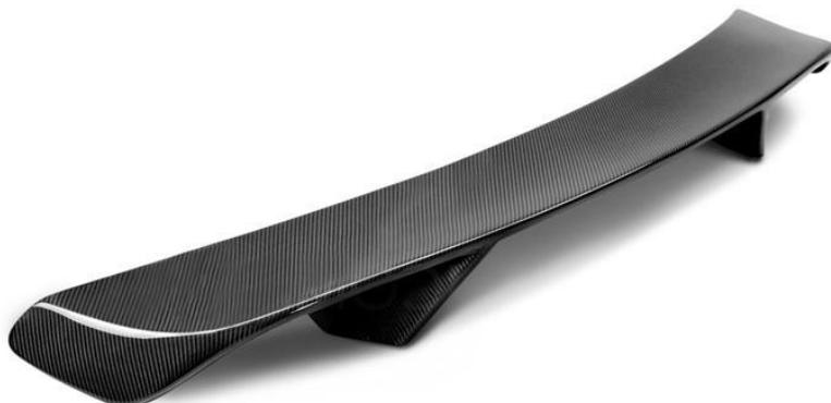
*Slika 17-Primjer proizvoda napravljenog slojevitim slaganjem kompozita [29]*
