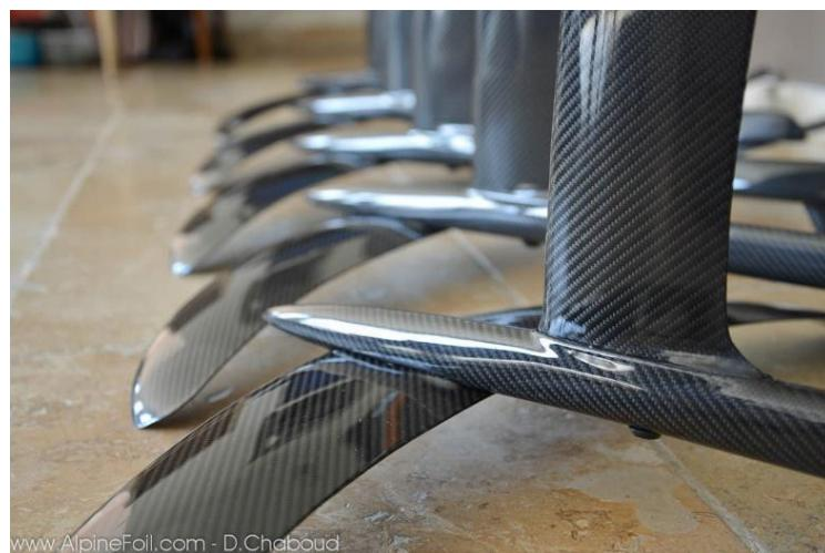
Slika 11-Hydrofoil od ugljičnih vlakana [23]
