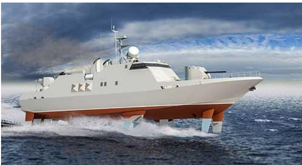
Slika 9-Hydrofoil vojna i komercijalna primjena [20], [21]
