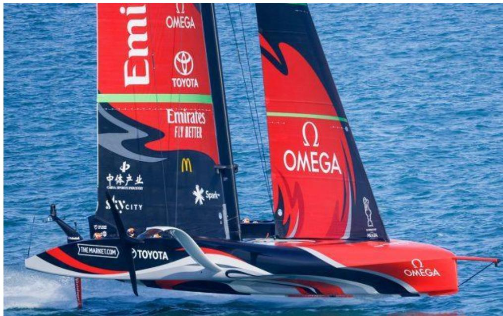
Slika 4-Moderna hydrofoil jedrilica [3]
