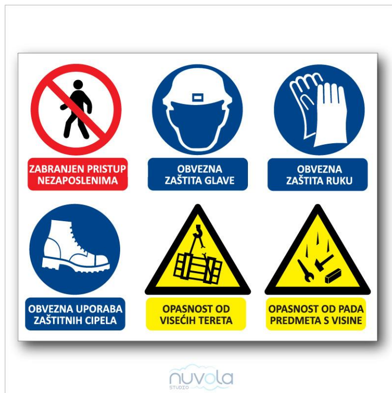
Slika 13. Znakovi upotrebljeni u prostoru rada dizalice [13]
