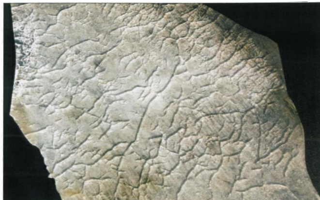
Slika 18. Fragment stakla bez oštih rubova, iznimno oštećen topline [10]
