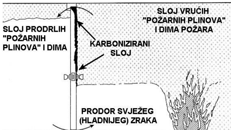
Slika 29. Pojava tragova karbonizacije iz smjera požara [12]
