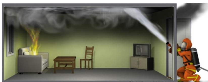
Slika 12. Usmjeravanje mlaza prema stropu [15]
