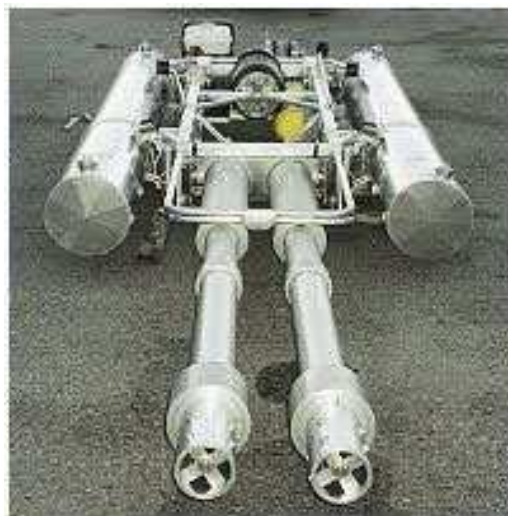
Slika 5. IFEX dual intruder pripremljen za montažu na Ecureuil Eurocopter AS350 jednomotorni helikopter.[16]
