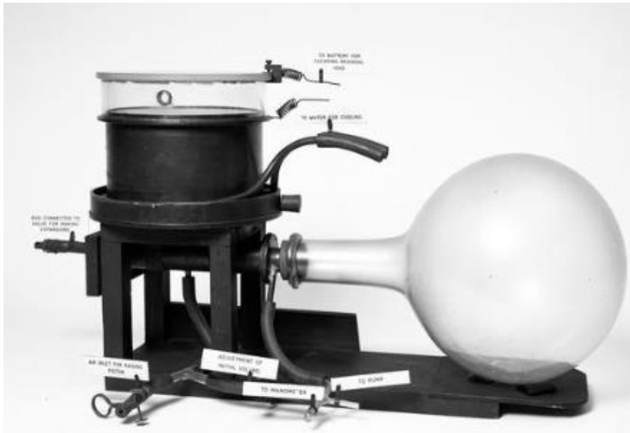
Slika 13. Originalna maglena komora napravljena u Cavendishev laboratoriju
