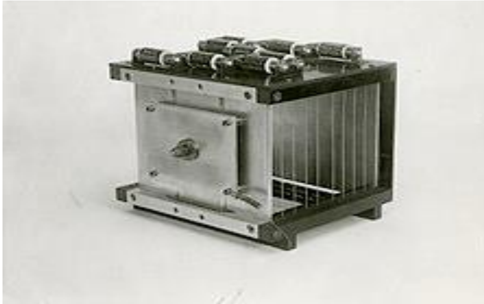
Slika 12. Prenosiva ionizacijska komora
