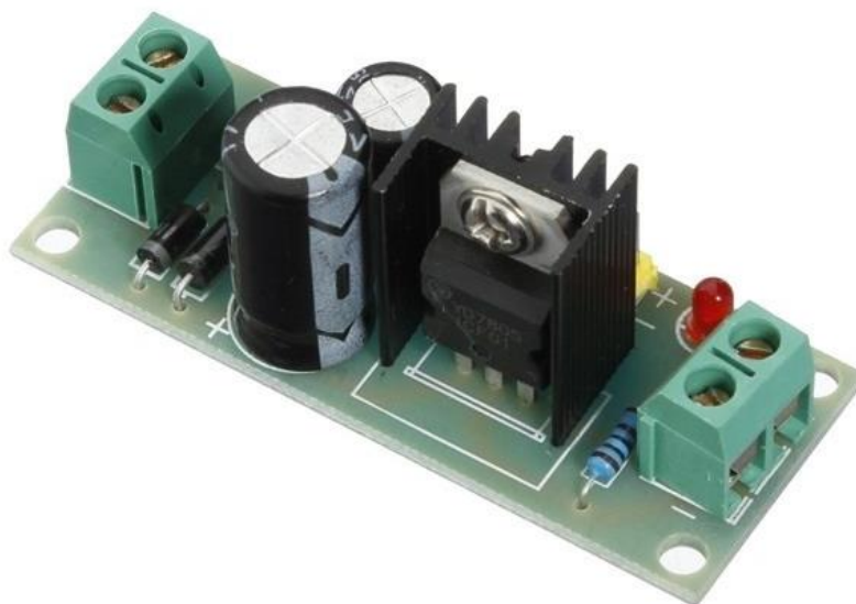
Slika 48. Predodžba LM7805 IC- regulatora u logičkom krugu sa hladnjakom [22]
