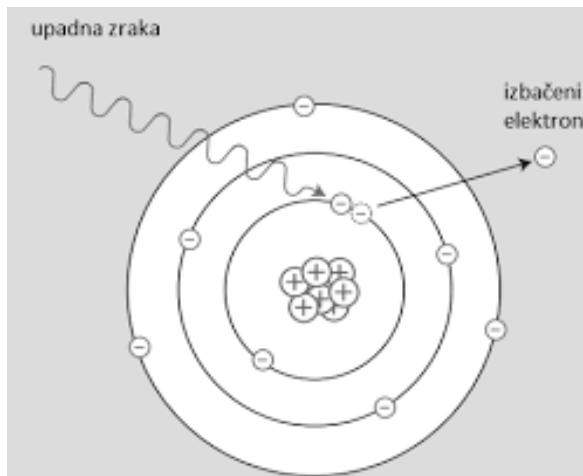
Slika 3. Fotoelektrični efekt [17]
