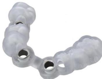
Slika 18. Fizički model dentalne vodilice izraden 3D printerom[23]
