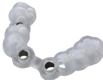
Slika 18. Fizički model dentalne vodilice izraden 3D printerom [23]
