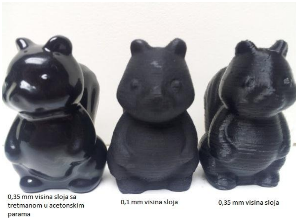
Slika 11. Obradak podvrgnut obradi u acetonskim parama [17]
