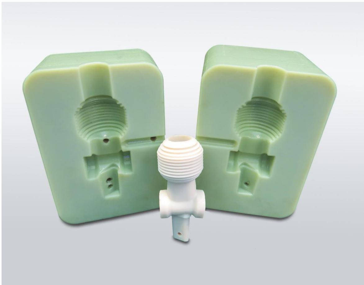
**Slika 6. Primjer RT (Rapid Tooling) korištenja AM tehnologije**
