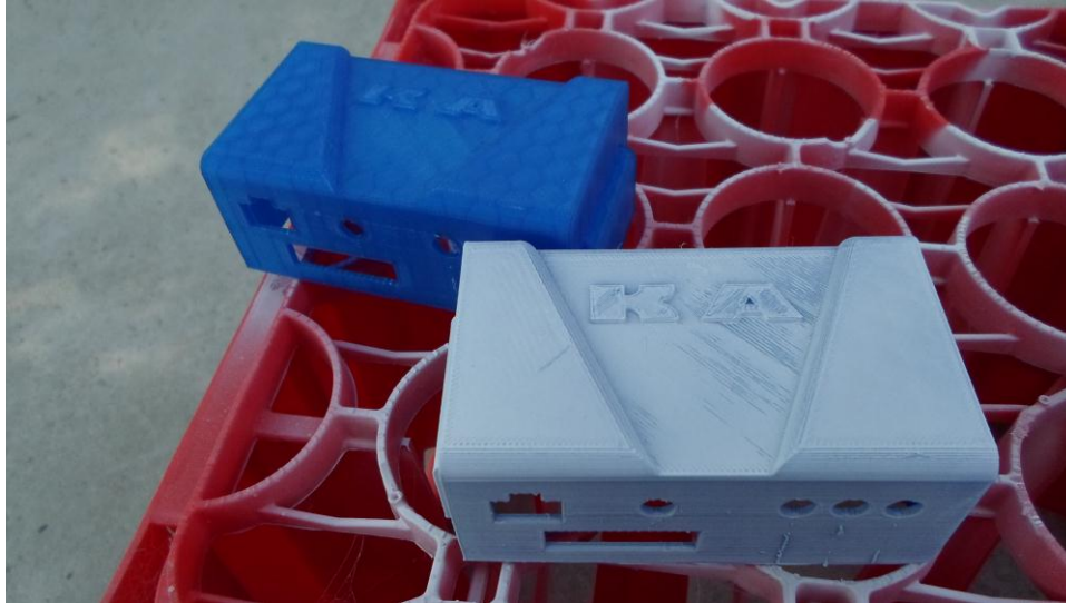
Slika 35. PLA proizvod nakon i prije nanošenja prevlake
