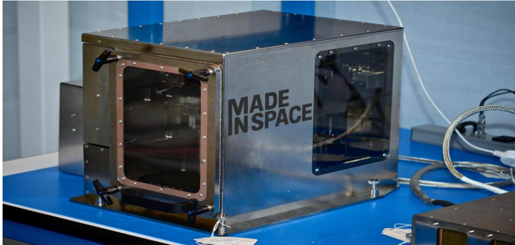
Slika 2. Zero-G 3D printer poslan na ISS stanicu [9]
