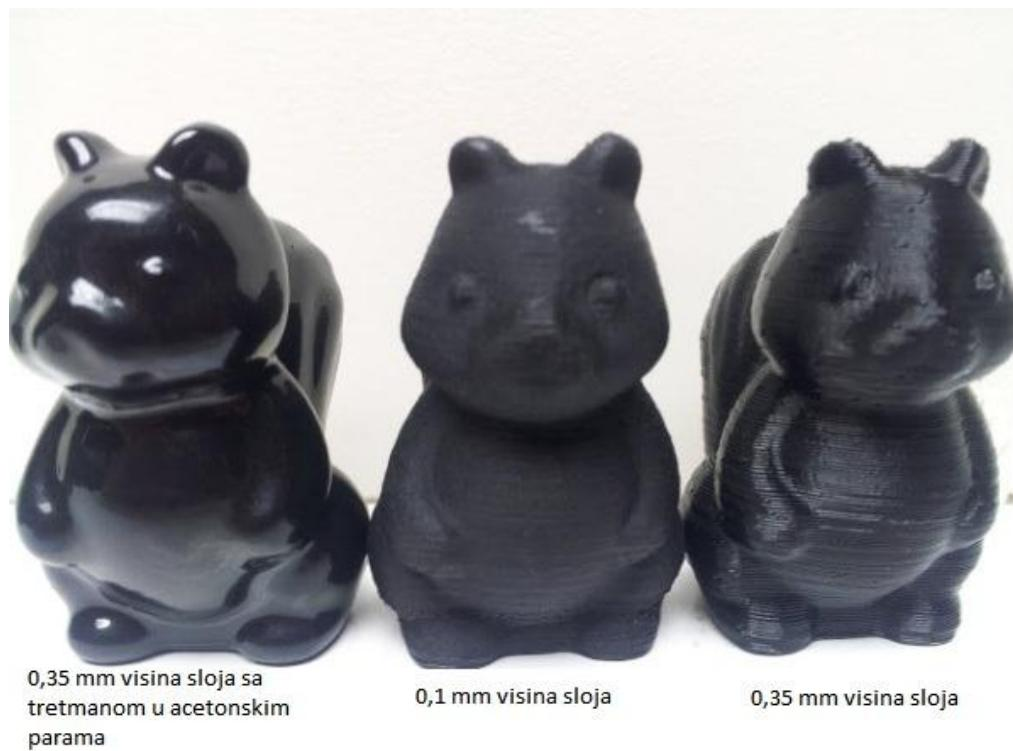
**Slika 11. Obradak podvrgnut obradi u acetonskim parama [17]**
