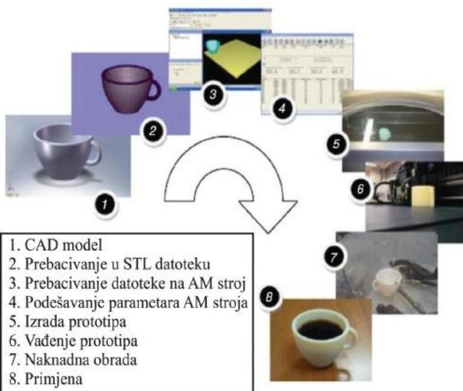
**Slika 7. Koraci izrade prototipa aditivnim postupkom [1]**
