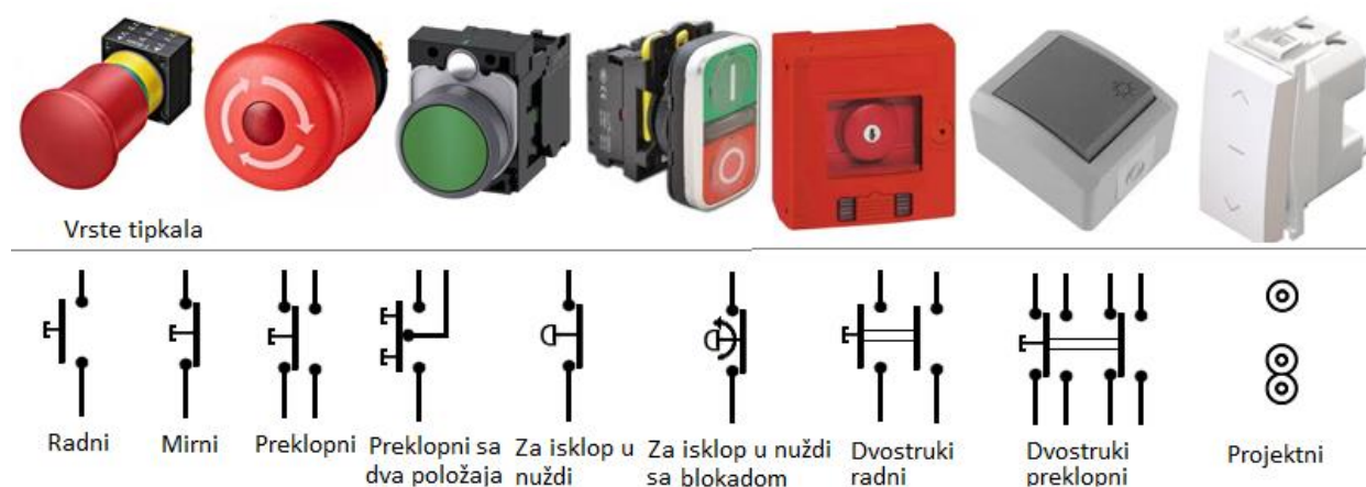
Slika 17. Predodžba tipkala i sklopki [16]
