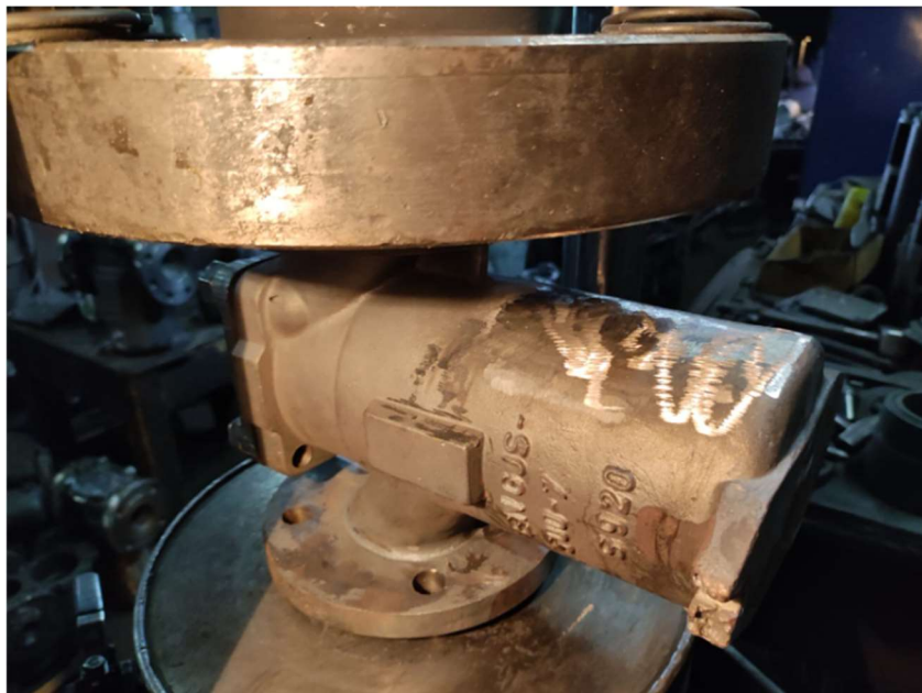
Slika 33. Ispitivanje odljevka na tlačnoj probi
