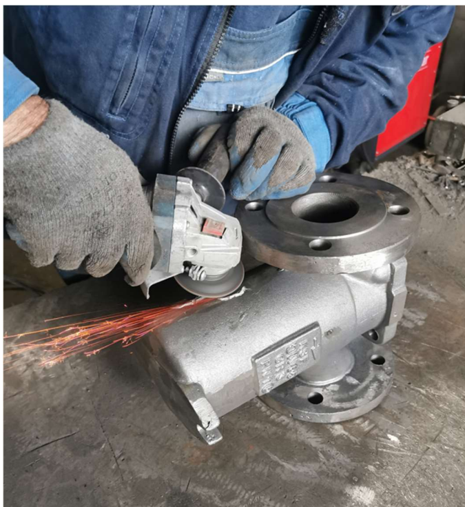
Slika 31. Brušenje zavara nakon zavarivanja pukotine
