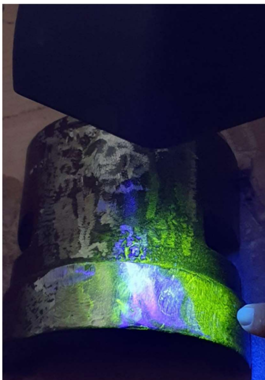
Slika 17 Ispitivanje ležaja magnetskom metodom
