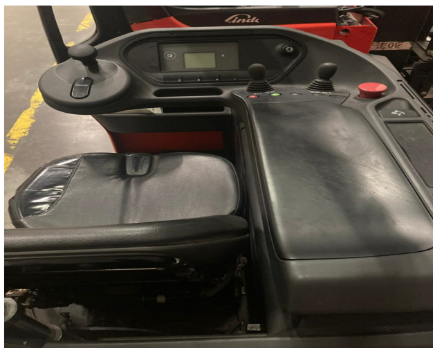
Slika 27. Prikaz kontroli viličara u izvedbi sa „joystick“ ručicom
