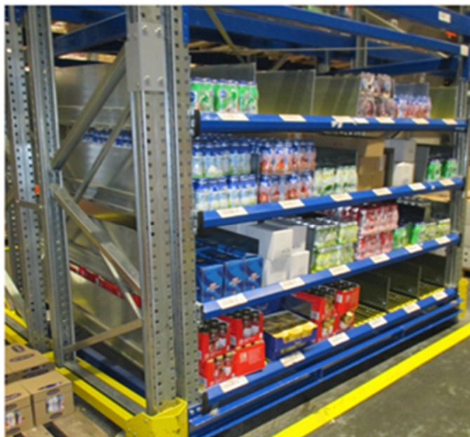
Slika 17. Nagibni regali u promatranom LDC – nagib omogućava da roba klizi prema radniku do dohvatne pozicije
