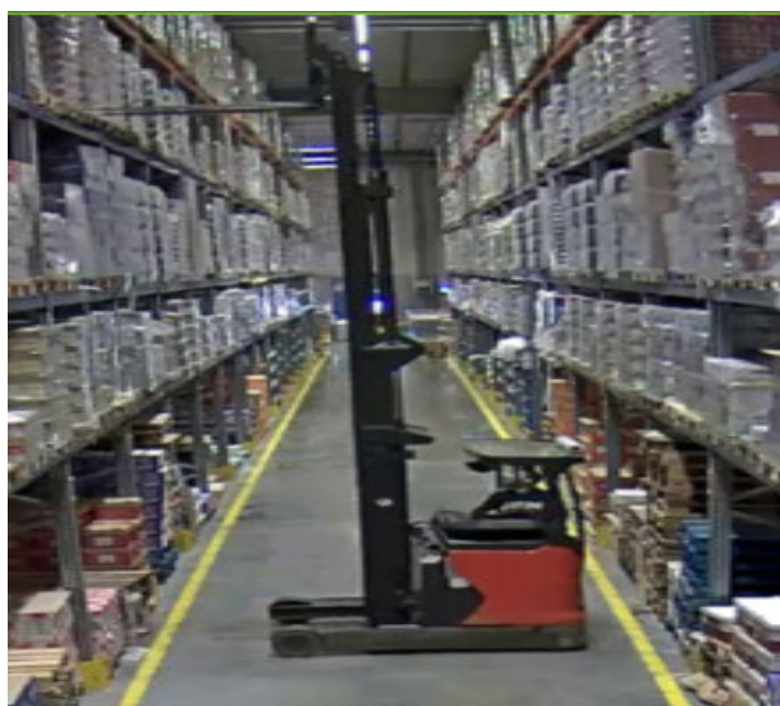
Slika 21. Regalni viličar Linde R20 u radu
