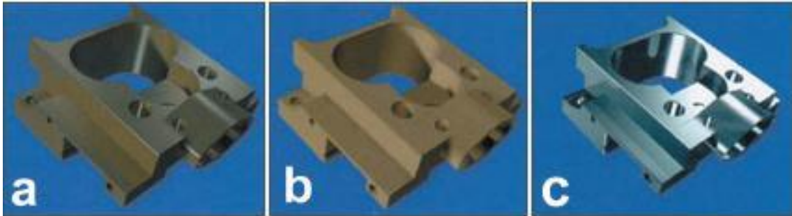
Slika 11.: a) Zeleni komad, b) smeđi komad i c) gotov komad
