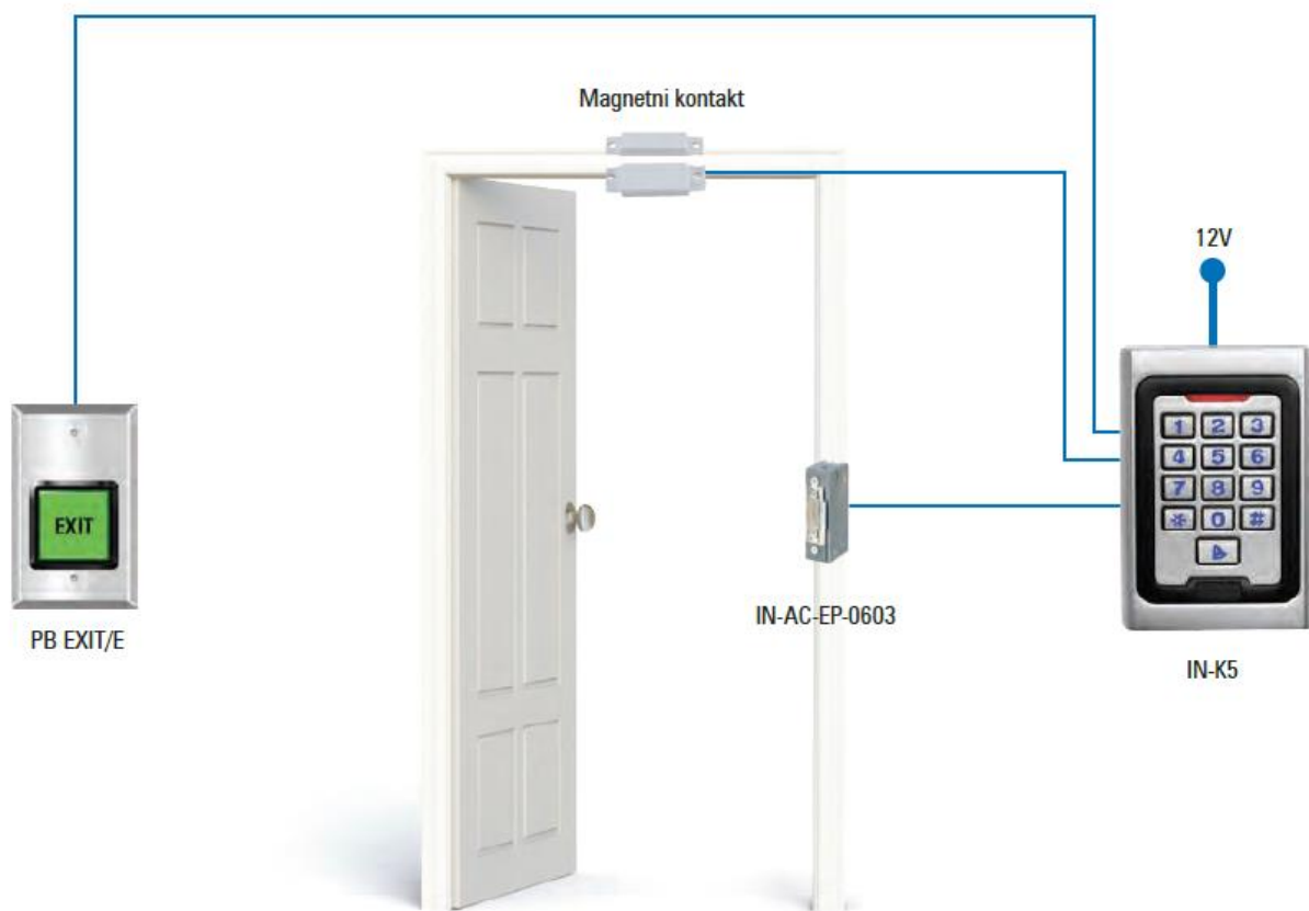
Slika 9. Sustav kontrole pristupa [2]
