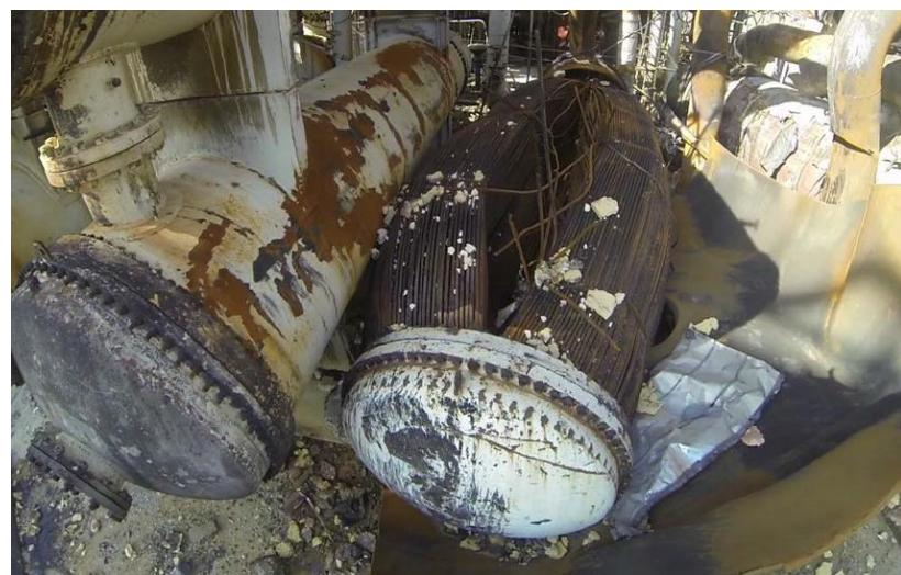
Slika 11. Izmjenjivač topline B na kojem je došlo do eksplozije [4]
