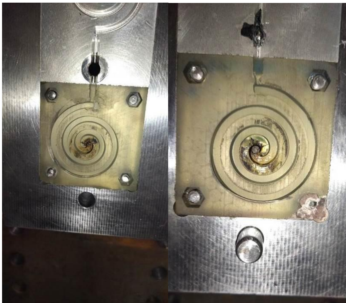
Slika 61. Izgled kalupa nakon trideset otpresaka
