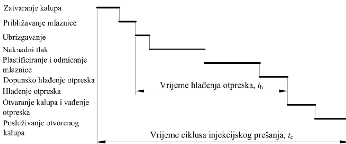
Slika 21. Dijagram ciklusa injekcijskog prešanja [21]
