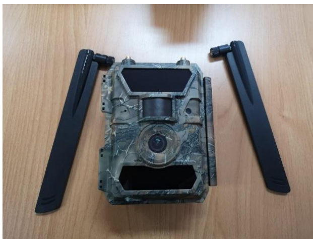
Slika 2. Predodžba dnevno-noćne kamere, s antenama za GPRS i GPS signal
