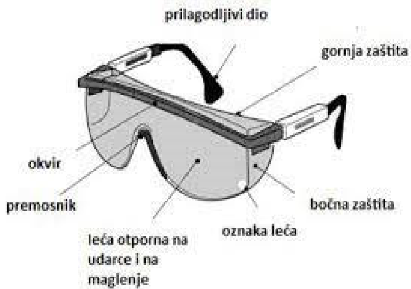
Slika 13: Zaštitne naočale i dijelovi [3]
