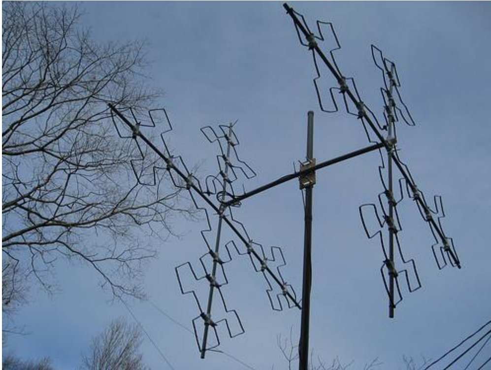
Slika 5. Kućna fraktalna antena model – quad, za prijem televizijskog programa.
