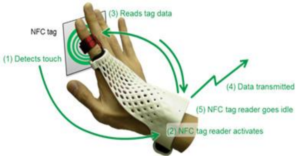
Slika 22. Koraci uključeni u rad kontrole snage [11]
