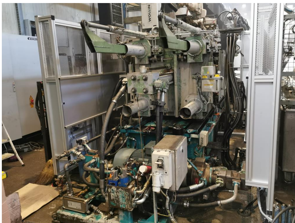
Slika 5: Pogonski sklop stroja za tlačni lijev
