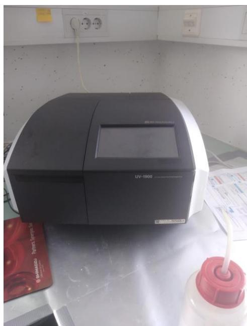
**Slika 7.** Uređaj za mjerenje absorbancije, SHIMADZU UV-1900
