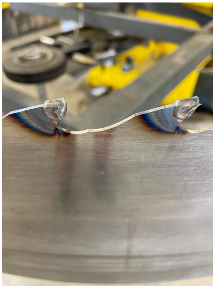
Slika 13. Zub stelita varen plazmom [8]
