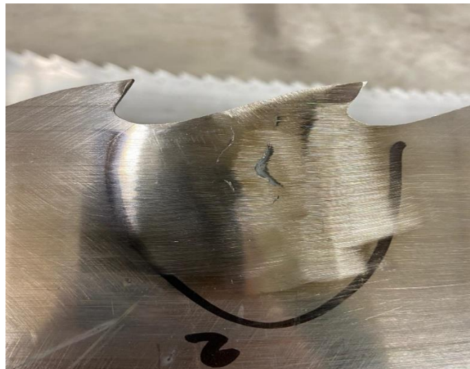
Slika 18. Var spreman za vizualnu inspekciju [8]
