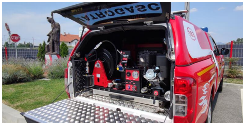
Slika 17. Visokotlačni modul ugrađen u vozilo (Izvor: https://vatropromet.hr/ ) [26]
