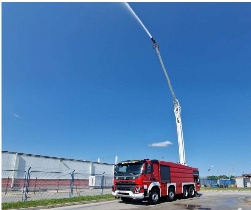
Sl.9. Navalno vozilo s artikuliranom rukom [7]
