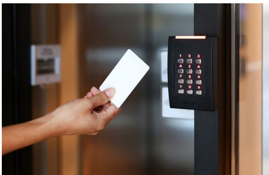
Slika 10. Kontrola pristupa autentifikacijskom pametnom karticom [14]
