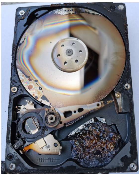
Slika 1. Oštećenje tvrdog diska pod utjecajem visoke temperature [9]
