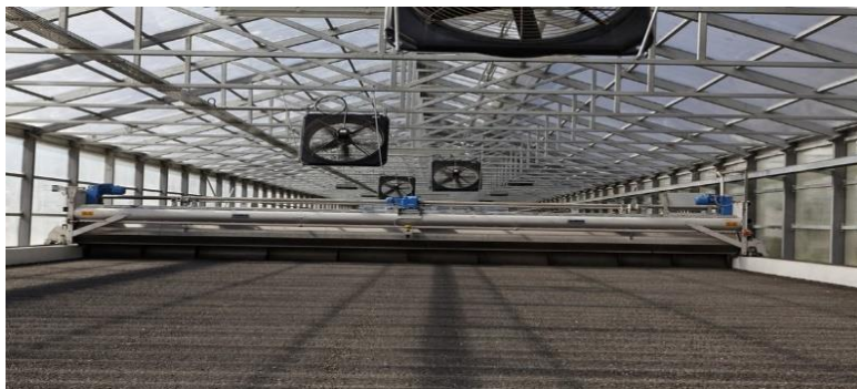
Slika 13. Solarno sušenje mulja
