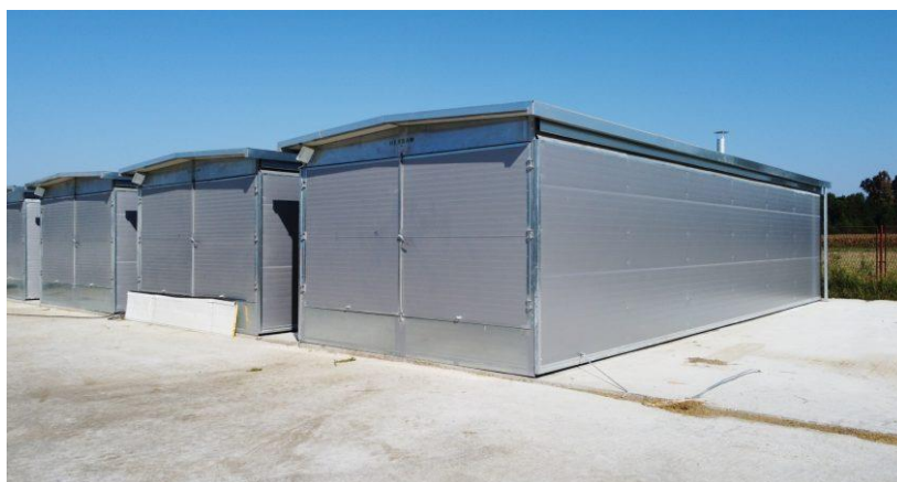
Slika 24. Sušara podna kontejnerska.,[36]
