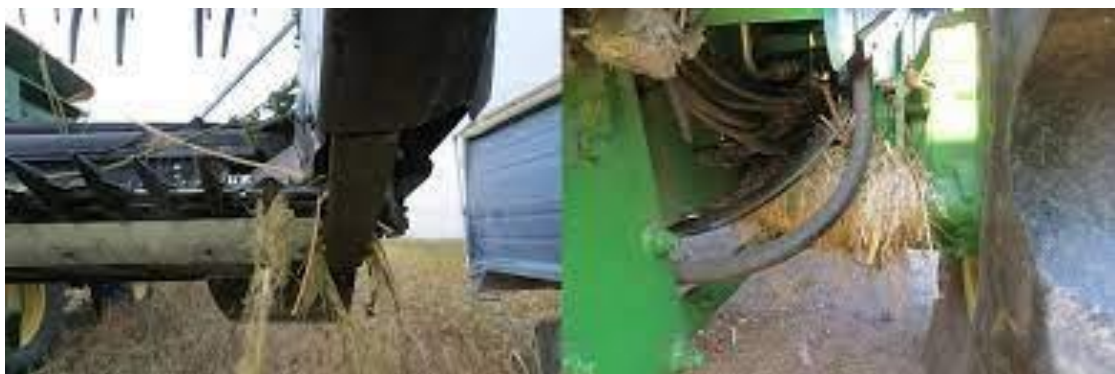
Slika 22. Zaplitanje oko noževa (lijevo) i vratila kotača kombajna(desno).,[35]
