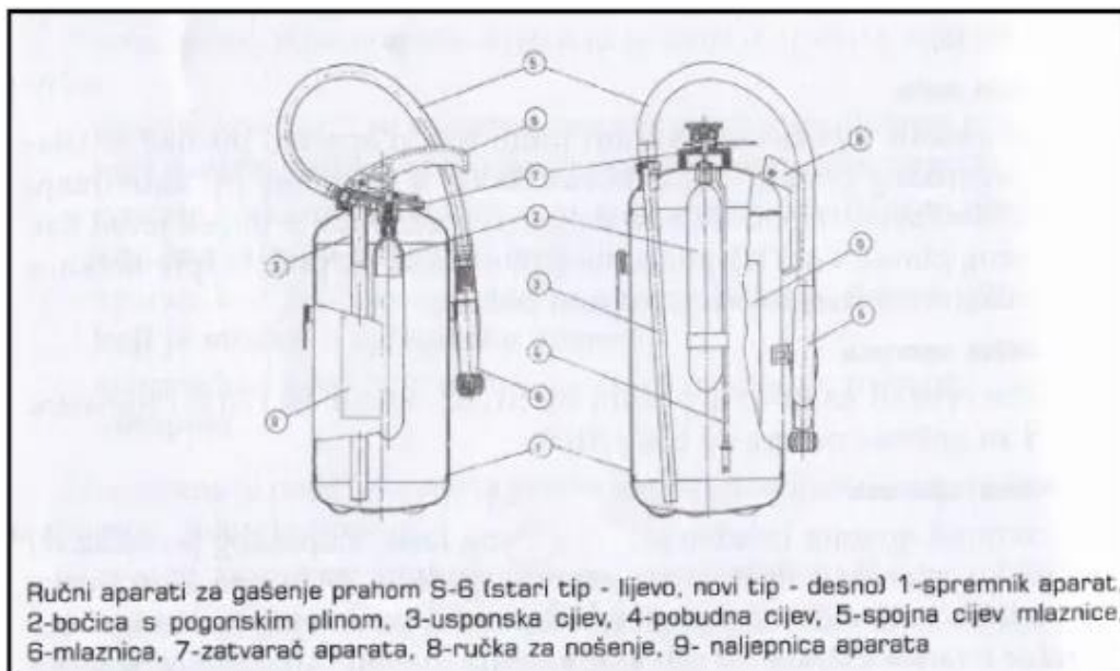
Slika 5. Prikaz aparata za gašenje prahom S6 i S9 s bočicom
