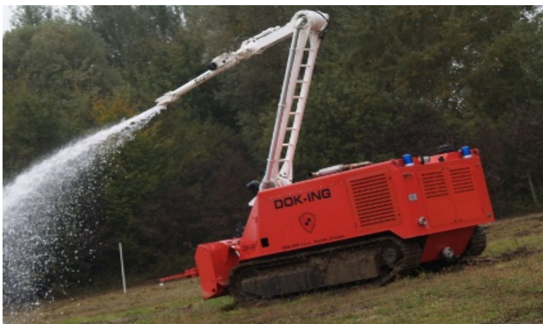
Slika 14. Višenamjenski robotizirani protupožarni sustav MVF-5 [14]
