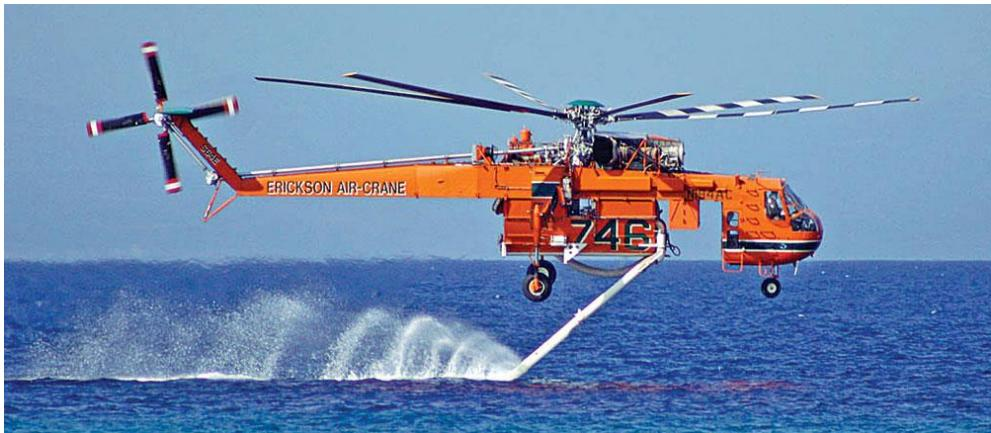
Slika 23. Punjenje preko hidrauličke cijevi u niskom letu [29]
