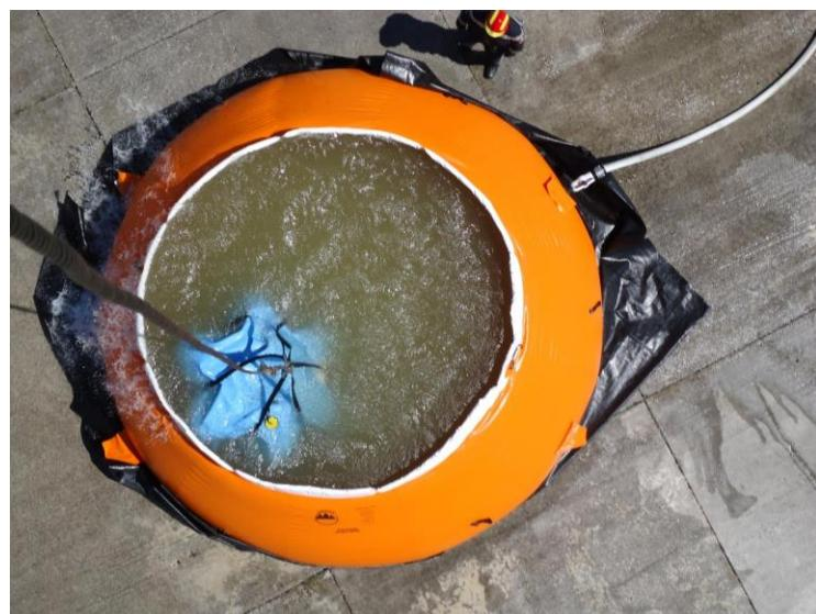
Slika 29. Gumeni otvoreni spremnik Fireflex tank 5060 [32]
