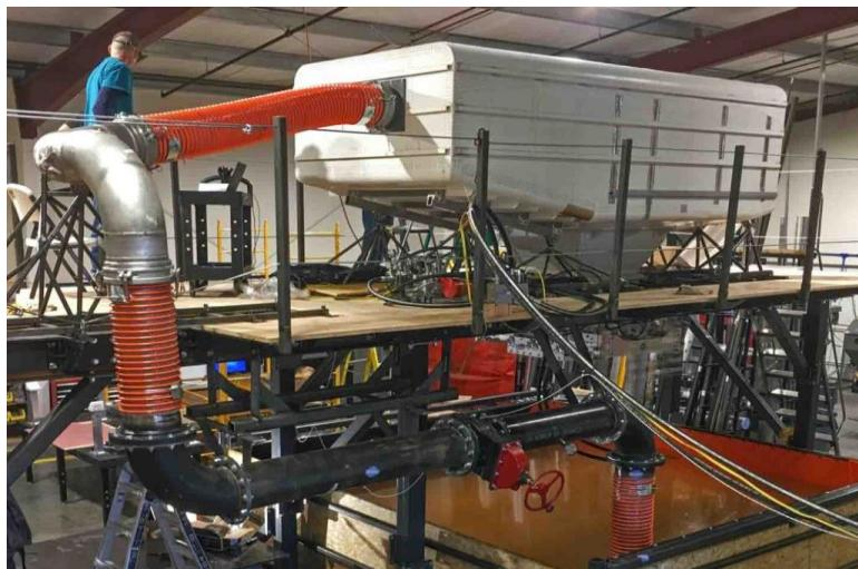
Slika 22. Ispitivanje spremnika helikoptera CH-47D Chinook [28]
