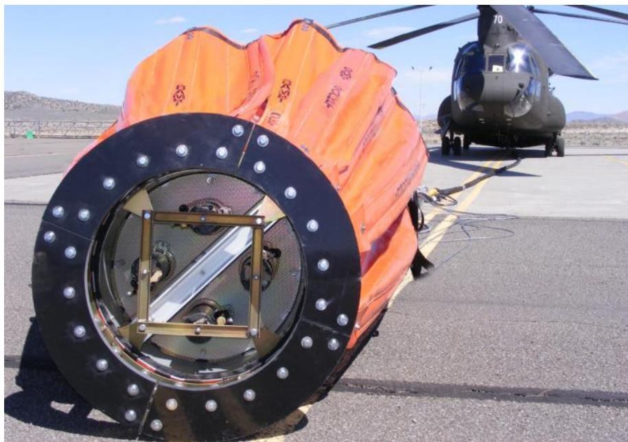
Slika 27. Zaimač Bambi Bucket sa Torrentula ventilom PowerFillom [33]
