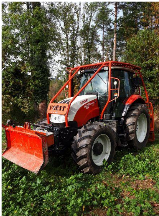
Slika [15]: Adaptirani poljoprivredni traktor
