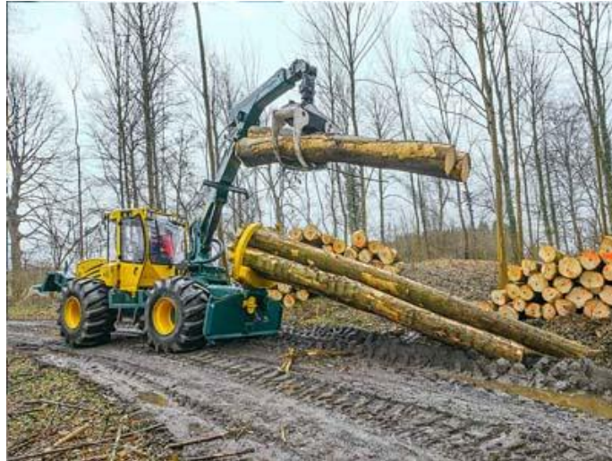
Slika [18]: Skidder sa kliještima i kranom
