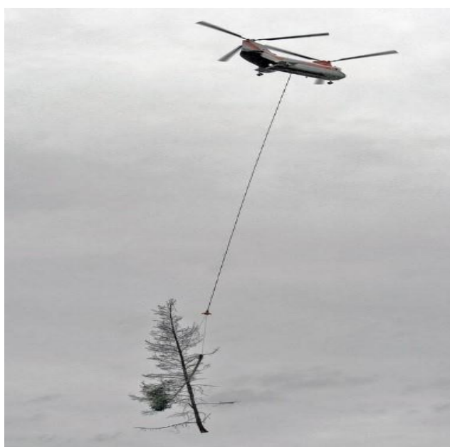
Slika [24]: Transport stabla upotrebom helikoptera
