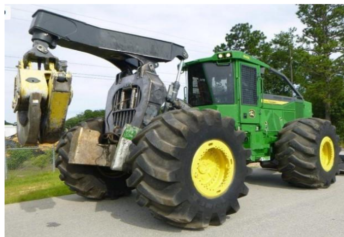
Slika [17]: Skidder sa kliještima
