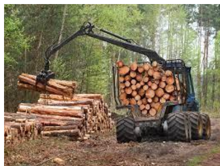
Slika [2]: Prikaz upotrebe forvardera drvnih sortimenata
