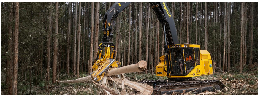
Slika [21]: Harvester tvrtke „Tigercat“ – na gusjenicama
