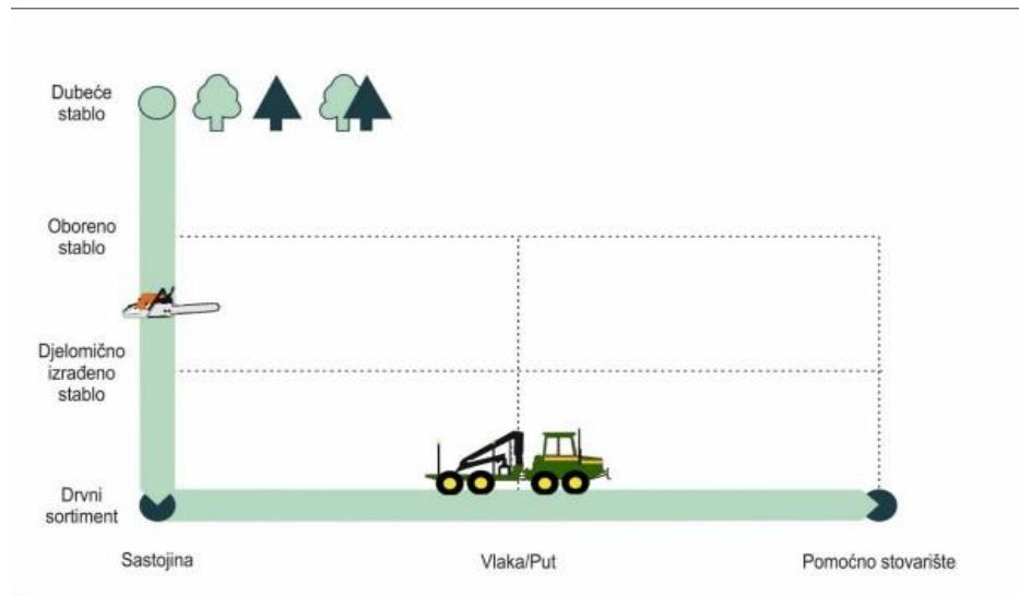
Slika [28]: Motorna pila - forvader
