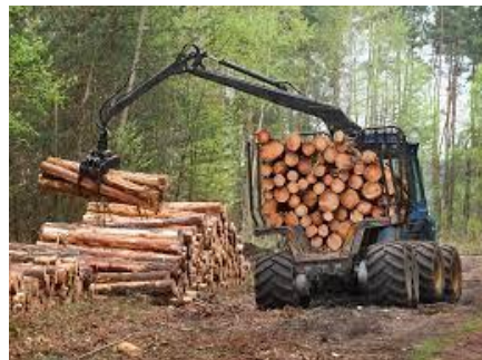
Slika [2]: Prikaz upotrebe forvardera drvnih sortimenata
