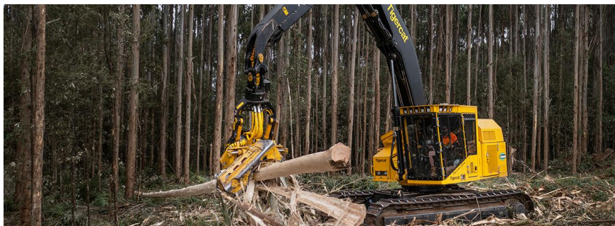
Slika [21]: Harvester tvrtke „Tigercat“ – na gusjenicama
