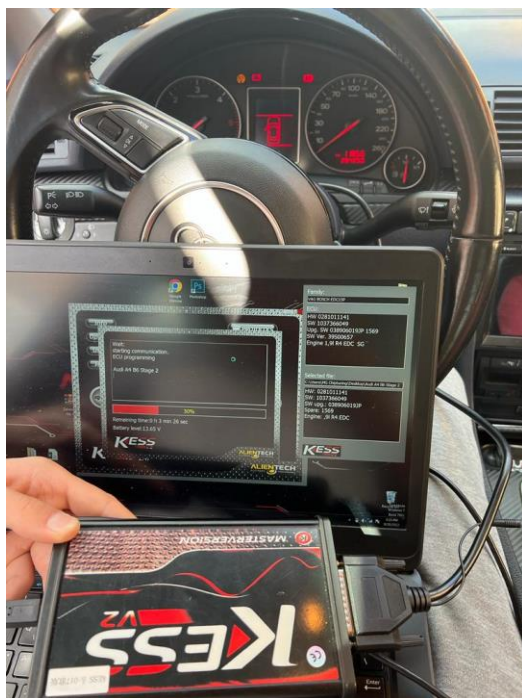
Slika 34. Upisivanje Stage 2 mape [29]
