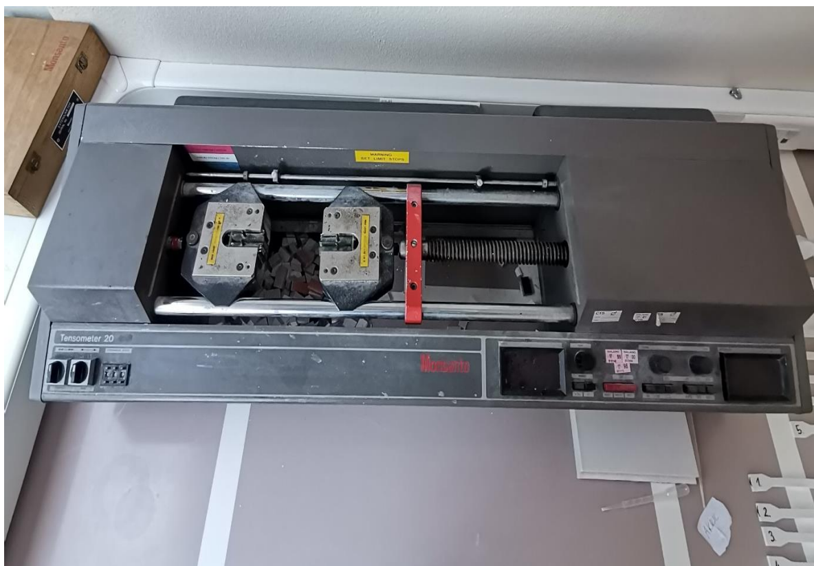
Slika 12. Kidalica Monsanto Tensometer 20
