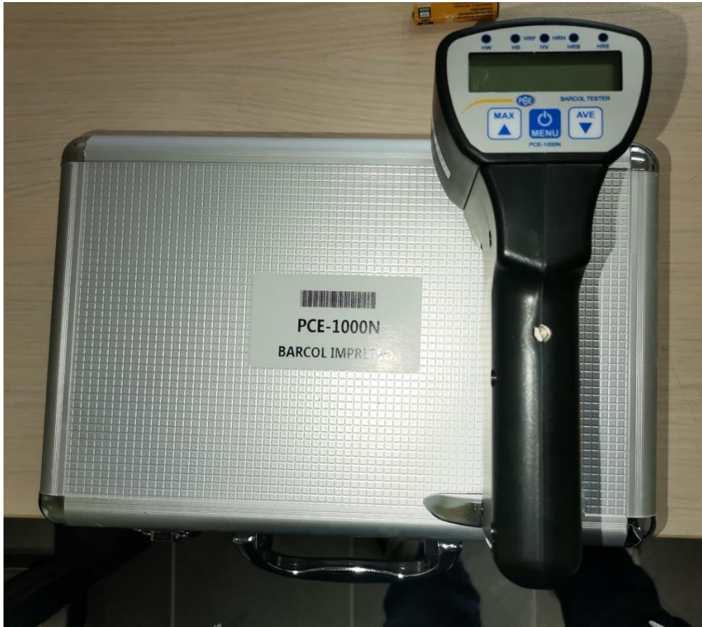
Slika 20. Barcol uređaj za ispitivanje tvrdoće
