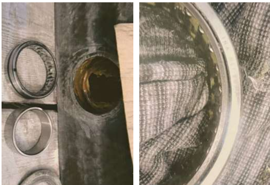
Slika 52 Kontrola ležajeva i njihovo zakretanje
