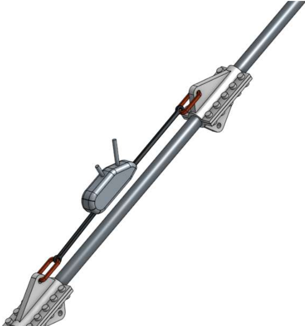
Slika 29 Natezanje užeta pomoću tirfora i klema
