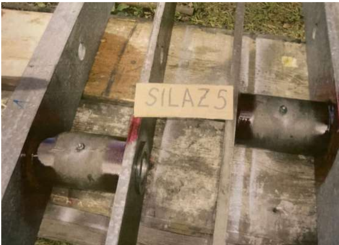
Slika 55 ispitivanje penetrantima podkonstrukcije velike i male vage (2)
