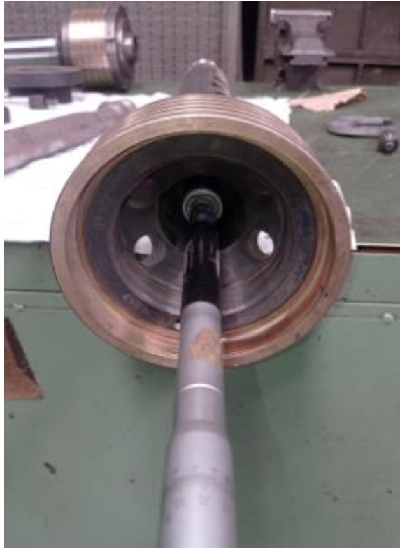
Slika 18. Klipnjača, \phi unutrašnji
