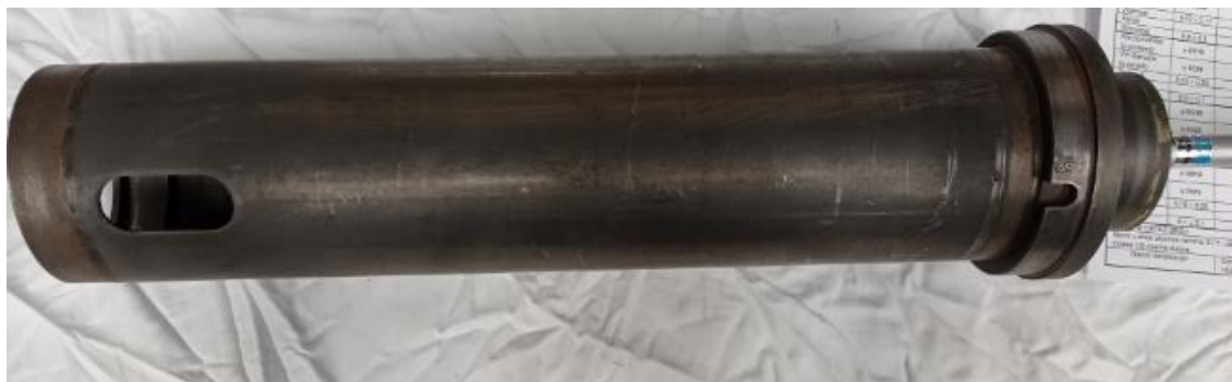
Slika 29. Cilindar srednji, kutija brtvjenja, \phi unutrašnji
