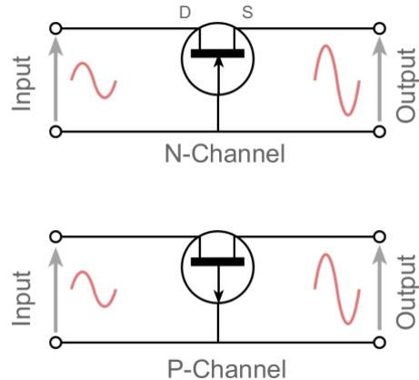
*Slika 17. JFET u spoju sa zajedničkim upravljačkim kanalom [28]*
