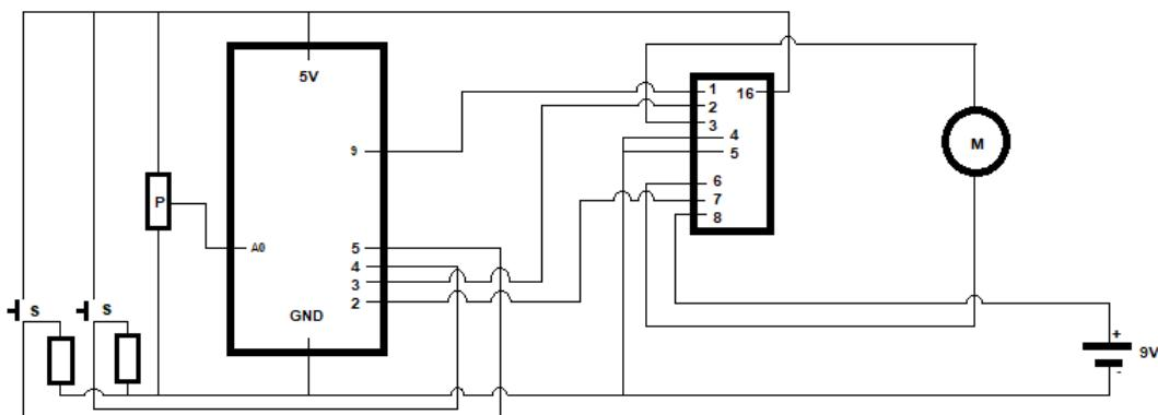
Slika 40. Shema spajanja istosmjernog elektromotora
