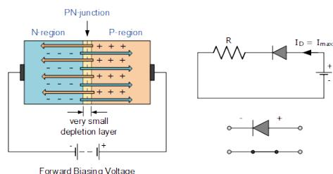
Slika 9. Propusno polariziran PN spoj poluvodičke diode [17]
