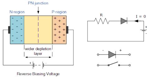
Slika 8. Nepropusno polariziran PN spoj poluvodičke diode [16]
