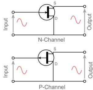
Slika 19. JFET u spoju sa zajedničkim odvodom [30]
