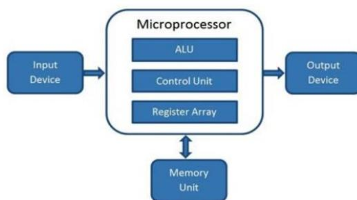
Slika 29. Dijelovi mikroprocesora [36]
